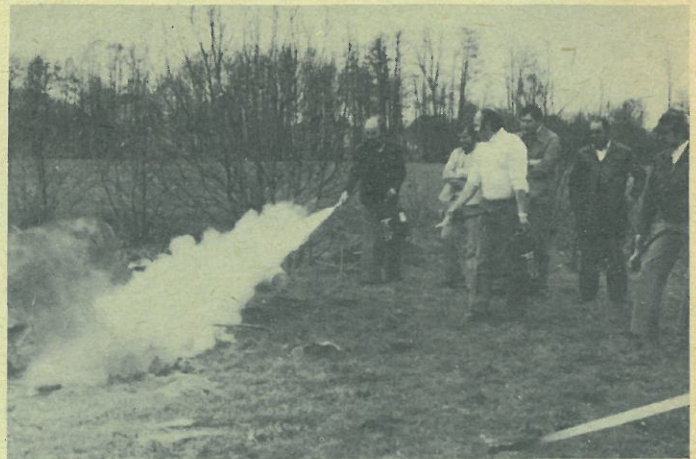
Bekämpfung eines Mineralölbrandes mit Handfeuerlöschern
