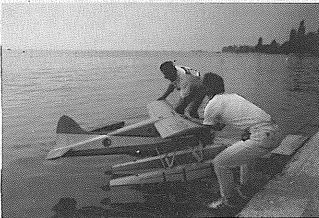
Bearer von Richard Geissler, 3m, 14 kg, Motor ZG 62 !
