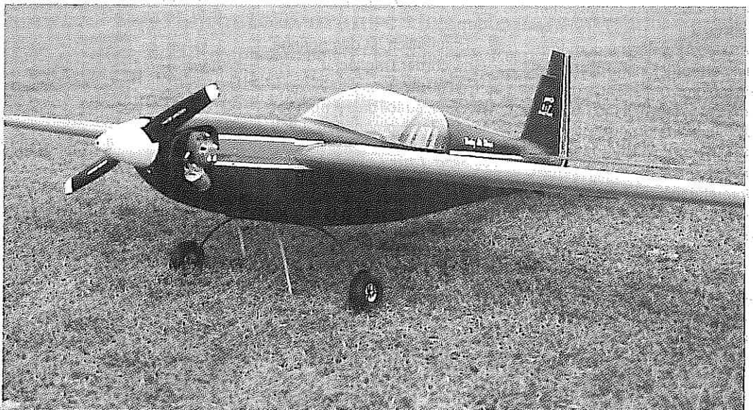
Vorbildlich gelöst auch der Antrieb mit einem 2 x 13 ccm Boxermotor, der kaum das Bild des eleganten Modells stört.
