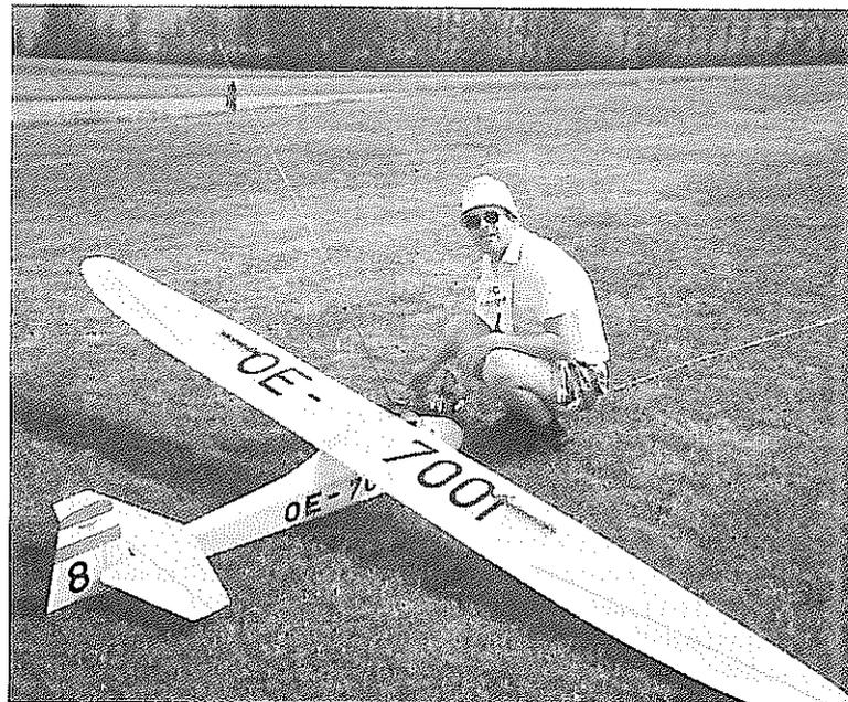
Ein hervorragend gebautes Antiflug-Modell, das "Grunau Baby IIb", gebaut und geflogen von Norbert Fischer/Fürth. Das im Maßstab 1:4 gehaltene Modell ist absolut vorbildgetreu und mit einer Spannweite von 3,40 m nicht gerade klein. Es erhielt auch einen Sonderpreis.
