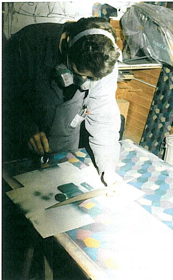
H. Hofbauer beim Lackieren der sogenannten "LOZENGE TARNUNG", wie sie auf deutschen Flugzeugen des ersten Weltkrieges verwendet wurde.
