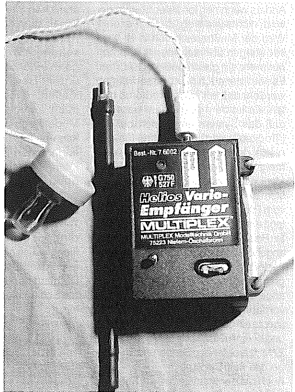
Die Empfangseinheit des Multiplex Helios Systems. In die Buchse „Betrieb“ bereits eingesteckt das Kabel zum Ohrhörer.
