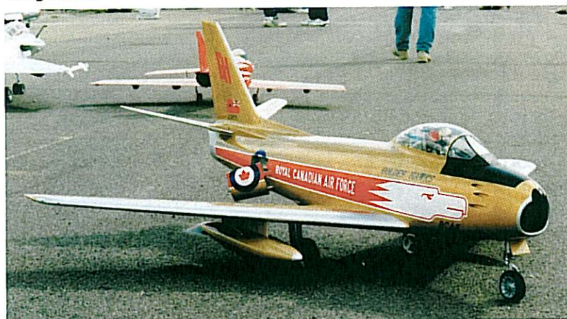
F86 Eigenkonstruktion von Martin Lefebre aus Canada mit Sophia J-450 Turbine. (Bild unten) Wroughton Airfield mit MIRAGE 2001 am Start.
