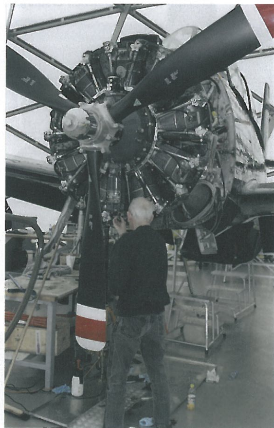
Im, verständlicherweise nicht zugänglichen, Hangar 8 wird an einer North American T28-B „Trojan“ Reg. OW. ESA gearbeitet. Im Bild der mächtige Curtiss Wright R 1820-86B 9-Zylinder Sternmotor mit 29 Liter Hubraum und einer Leistung von 1.400 PS.
