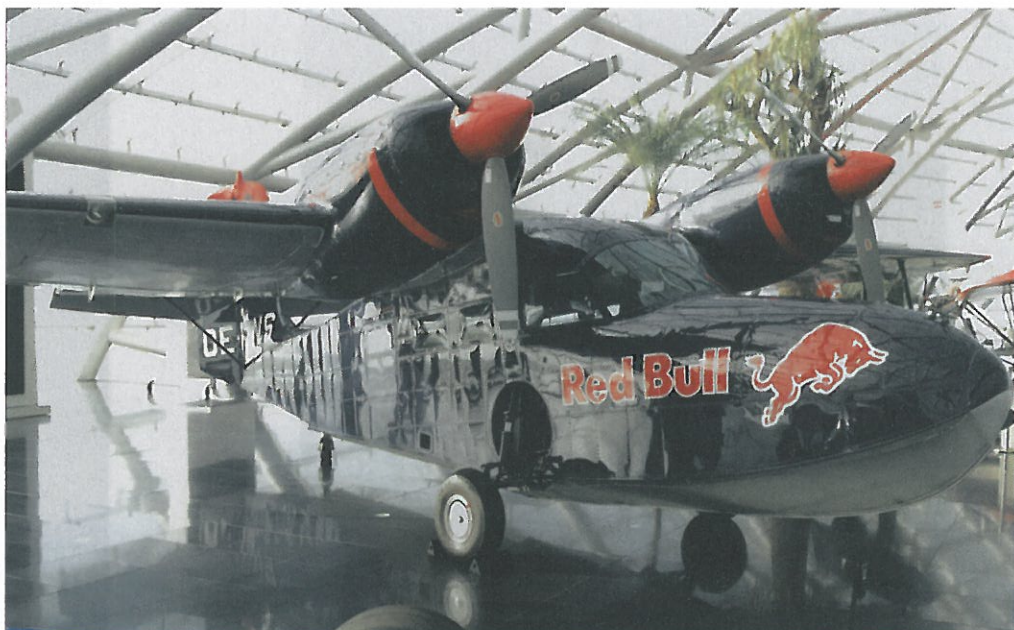
Sie landet auf der Donau und auf den Seen, eine Sensation im Binnenland Österreich. Die Gruman G-44 „Widgeon“ OE-FWS, Bj. 1956, kam 2001 nach Salzburg. Spannweite 12 m, Reisegeschw. 220 km/h, 2 Lycoming 6 Zylinder Boxer Motoren mit je 295 PS.
