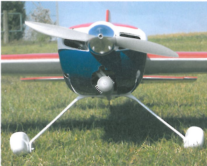
Der Magnum passt mit dem Normalschalldämpfer ausgezeichnet unter die Motorhaube
