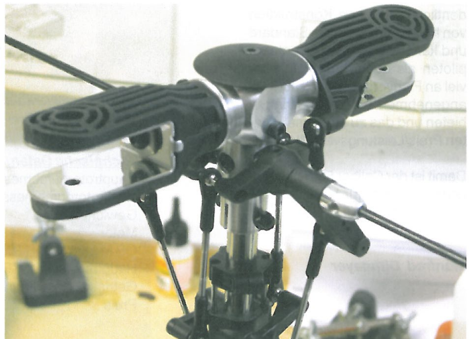
der sehr gut gebaute Rotorkopf mit Metallsparrenverstärkung
