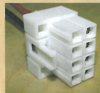
Der achtpolige Stecker des Motorreglers in der Nahaufnahme (rechts).
