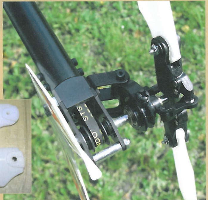
Oben die mit je zwei Radiallagern versehenen Heckrotor-Blatthalter inklusive Nabe, links die Pitch-Schiebehülse. Unten die komplette riemengetriebene Heckereinheit. – Im Bild unten links ist sowohl das Standard-Heckrotorblatt (oben) als auch die modifizierte Shuttle -Variante zu sehen. Letztere ist etwa 12 mm kürzer und mit einer kleinen Messingbuchse versehen – die perfekte Lösung für ein ruhiges Heck.
