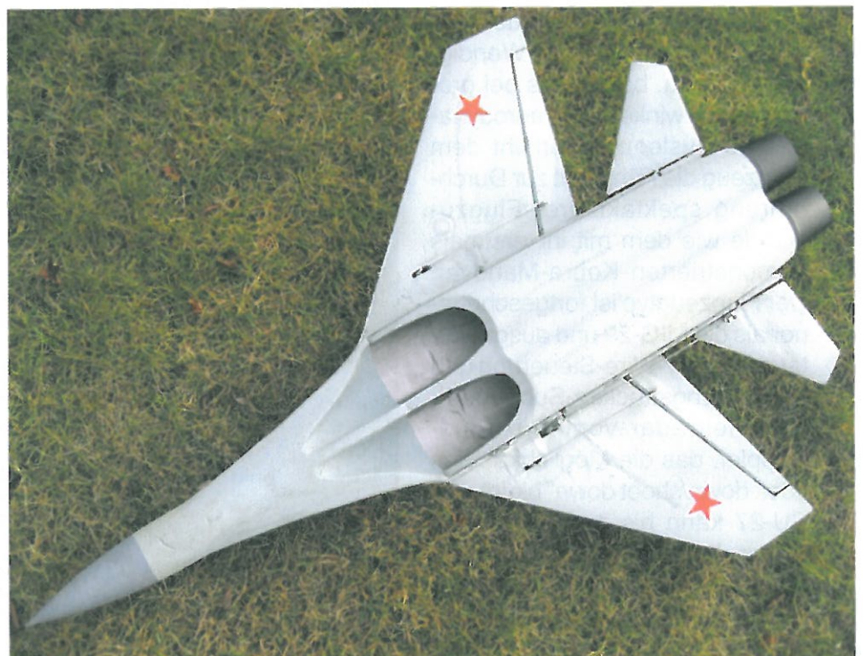
Die breiten Einlässe versorgen die Impeller mit ausreichend Luft
