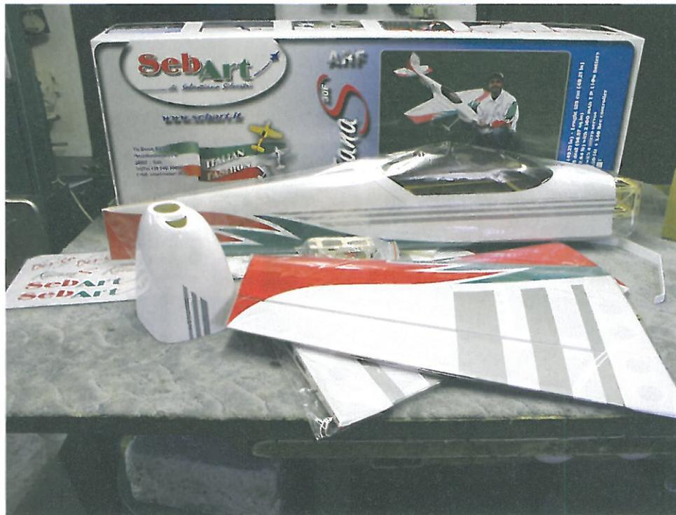
Alles fein säuberlich verpackt kamen zwei fertig gebaute Tragflächenhälften samt Kohlefasersteckungsrohr, der Rumpf, das Leitwerk, eine weiß lackierte Motorhaube aus GFK, eine braun getönte Kabinenhaube mit den genialen Magnetverschlüssen, ein Alu-Fahrwerk, weiß lackierte Radverkleidungen
