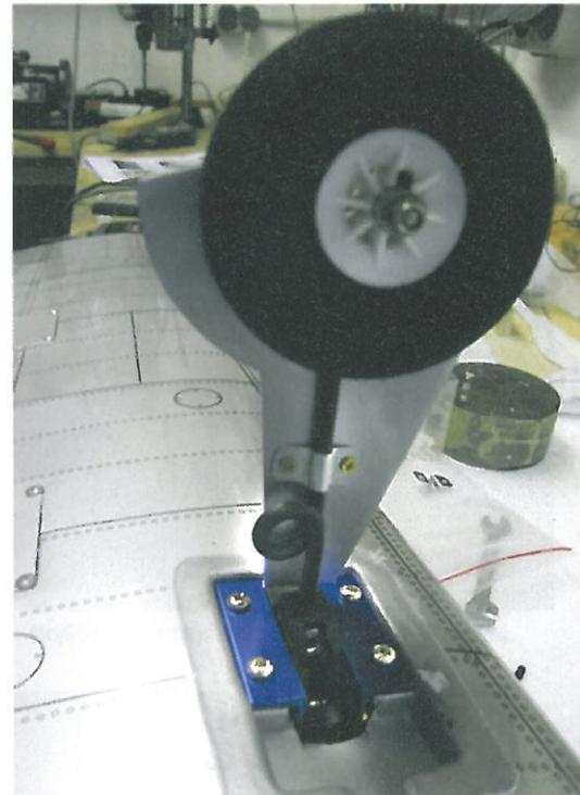
Das Fahrwerk mit Fahrwerksklappen. Für raueren Pistenbetrieb sollte die Verkleidung abgenommen werden.
