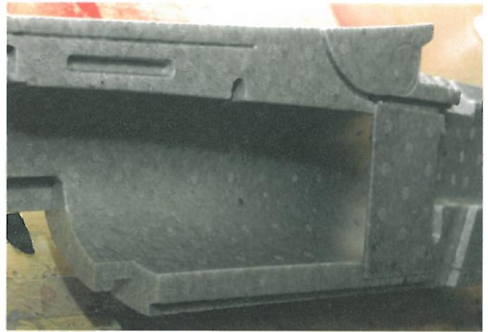
*Die ausgezeichnete Luftführung zum Impeller zeugt auch von gekonntem Formenbau bei Multiplex*
