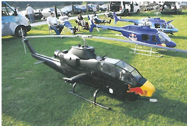
**Sepp Schmir: Im Vordergrund die Cobra mit einem Rotordurchmesser von 3,35m einem Gewicht von 23,5kg und von einer Jakadofsky Turbine angetrieben**
