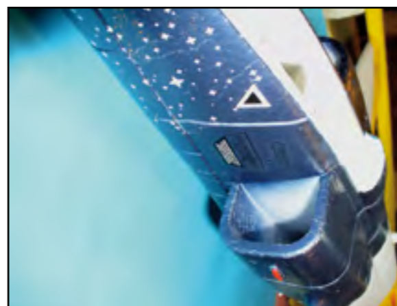
Ein Blick auf den linken Lufteinlauf zeigt, dass diese groß genug ausgeführt sind, sodass der Impeller im Flug gut atmen kann.
