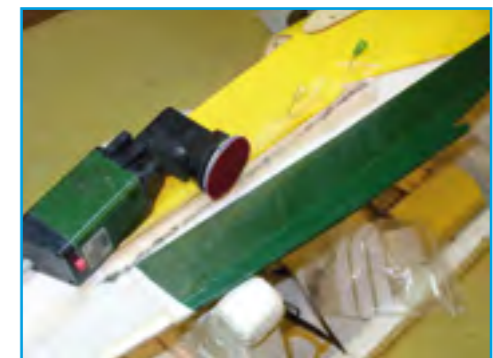
Den überstehenden Wulst schleift man am besten mit einem Schleifgerät weg. Hier kommt ein Tellerschleifer der Marke Minitool zum Einsatz.
