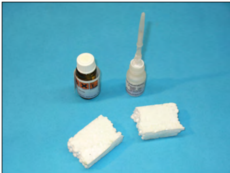
Sogar das Verkleben von echtem Styropor ist mit Hilfe des Primers machbar. Jeder andere herkömmliche Sekundenkleber kann hier nicht eingesetzt werden, denn er würde das Styro auflösen.
