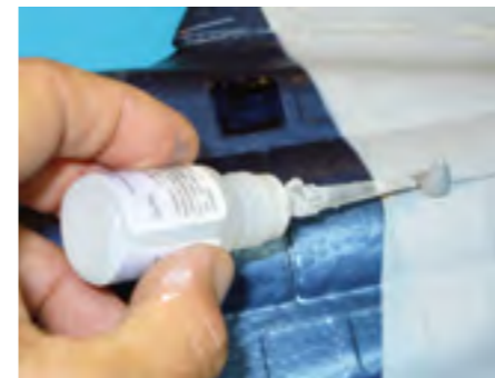
Auch die Antenne kann mit dem Industrieklebstoff am Rücken des Modells befestigt werden. Falls das Modell aus echtem Styropor bestehen sollte, müsste man hier vorher noch den speziellen Primer verwenden.
