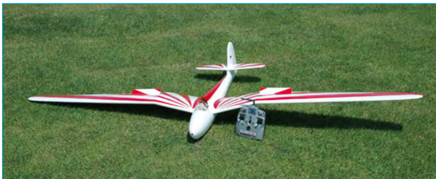
In ca. 30m Höhe werden die Störklappen ausgefahren. Bei knapp 30 km/h sinkt das Modell mit gut 3-4 m/s und setzt souverän auf der Graspiste langsam ohne jede Tendenz zum Strömungsabriss auf.
