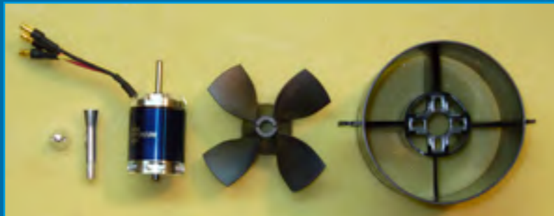
Die Antriebskomponenten des Impellers sind ausgenommen Motor bereits im Bausatz enthalten. Als Antriebsmotor kommt ein Hyperion HS-2221 zur Anwendung.
