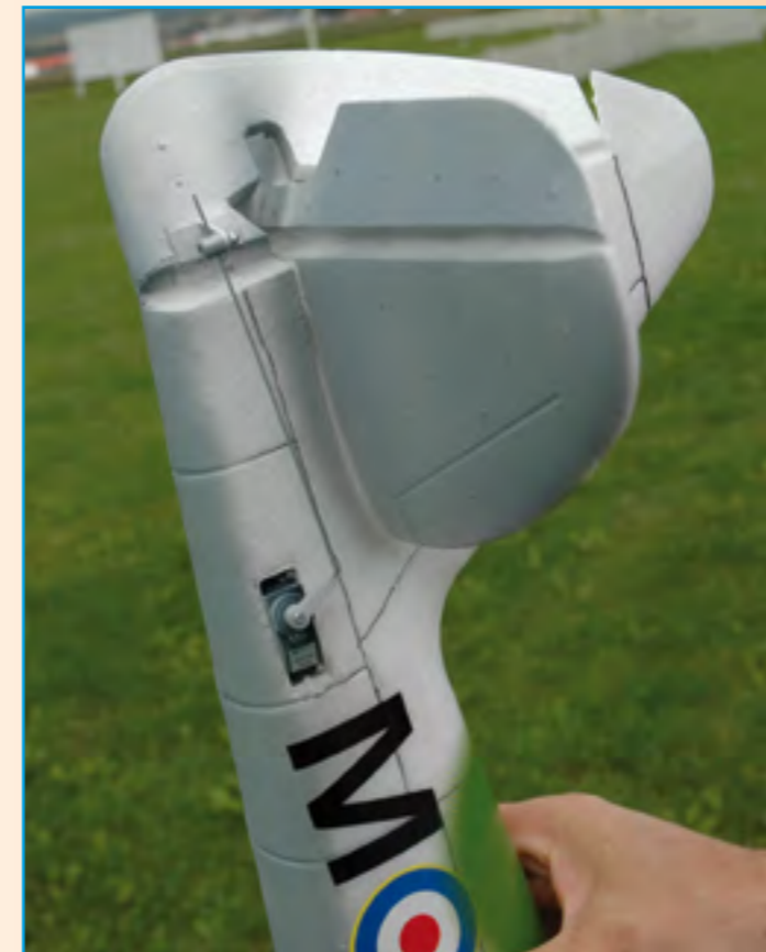
Beim Testmodell wurde auch das Seitenruder angelenkt. Nicht unbedingt erforderlich aber hilfreich!
