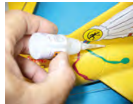
Das Verkleben von EPP, wie hier zu sehen beim Nanojet von Robbe kann problemlos erfolgen. Schon nach wenigen Sekunden ist die Klebeverbindung fest und nach ca. 12 Stunden voll belastbar.
