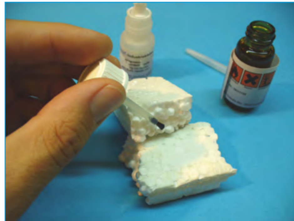
Vor dem Einsatz des Klebers sind beide Flächen mit dem Primer einzustreichen und nach einer kurzen Abluftzeit von einer Minute kann der Industriekleber einseitig aufgetragen werden.
