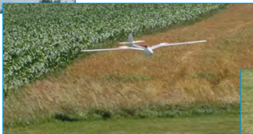
In ca. 30m Höhe werden die Störklappen ausgefahren. Bei knapp 30 km/h sinkt das Modell mit gut 3-4 m/s und setzt souverän auf der Graspiste langsam ohne jede Tendenz zum Strömungsabriss auf.
