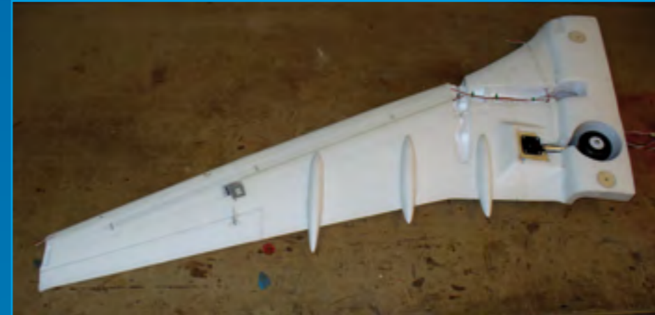
Die zum Lackieren fertige Tragfläche mit allen Einbauten, wie Querruderservo, Einziehfahrwerk und Kabel für die Beleuchtung.
