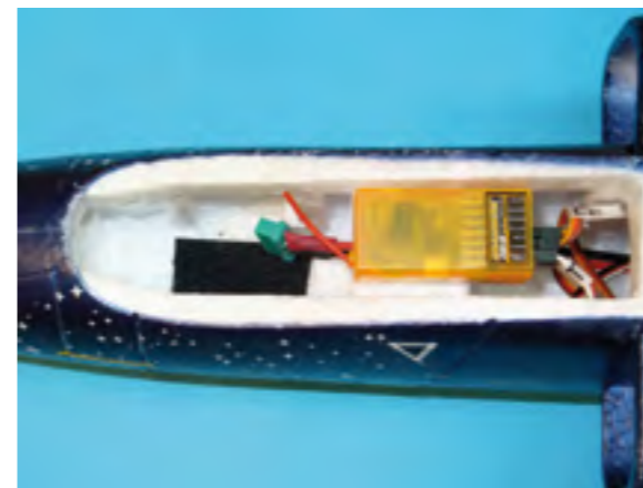
Als Empfänger genügt ein einfacher fünf Kanal-Empfänger, da nur drei Funktionen (Gas, Querruder und Höhe) vorhanden sind. Bei der AMX des Autors kommt ein günstiger sechs Kanal- Orange DSM2-Empfänger zum Einsatz, mit dem es bisher keine Reichweiten-Probleme gab.
