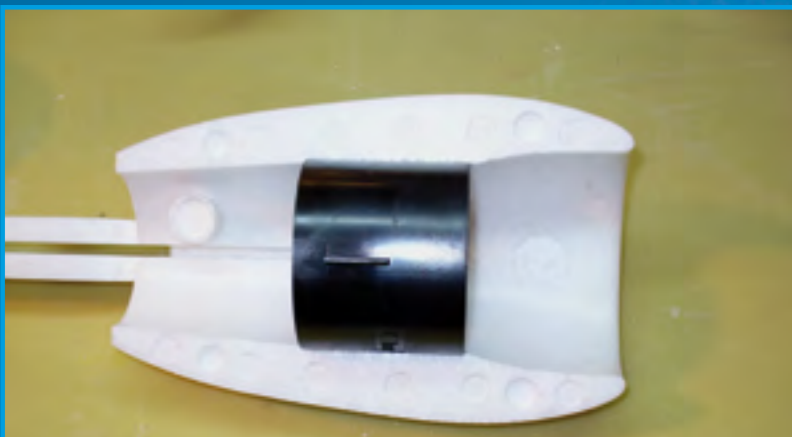
Die Innenseite der Triebwerksgondel bedarf zur Optimierung der Luft-Strömung noch Einiges an Nacharbeit
