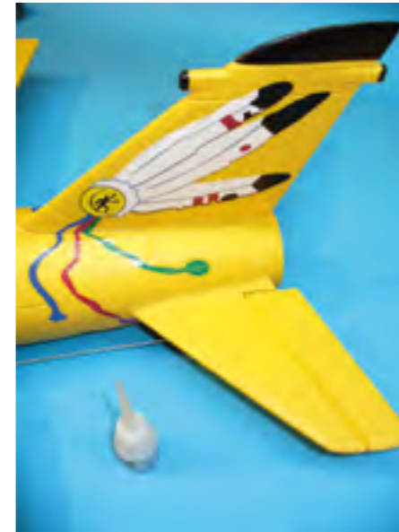
Das hier mit dem Rumpfrücken verklebte Seitenleitwerk kann nach dem Verkleben noch kurz ausgerichtet werden, bevor die Klebeverbindung endgültig ihre Festigkeit erlangt.
