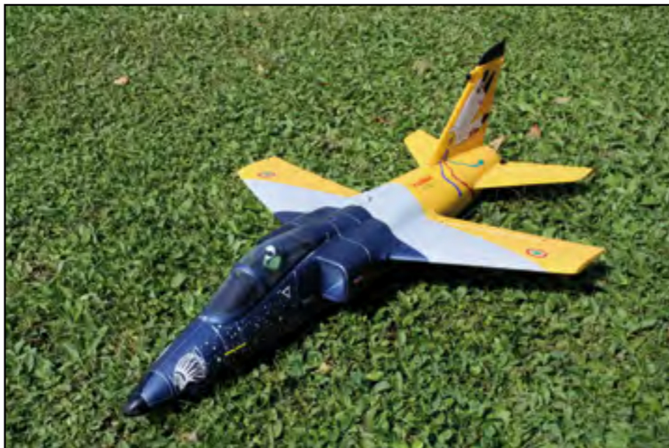
Das fehlende Fahrwerk macht Landungen auf Rasenpisten zum Vergnügen. Beim Landeanflug, Antriebsmotor abstellen und Modell einfach ausschweben lassen bis es auf der Rasenfläche aufsetzt.
