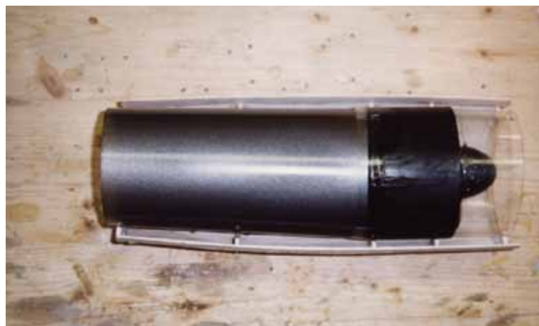
In die eine Hälfte der fertigen Triebwerks gondel wird der WEMOTEC- Impeller samt Einlauf und Düse eingebaut und mit der zweiten Hälfte verschlossen.
