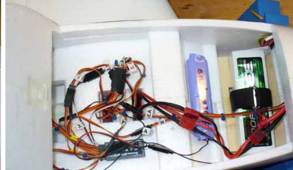
Sehr viel Platz für sehr viele Kabel! Der Flugakku liegt hier quer im Rumpf, wodurch ein Verrutschen verhindert wird. Hier hat wirklich wer mitgedacht!
