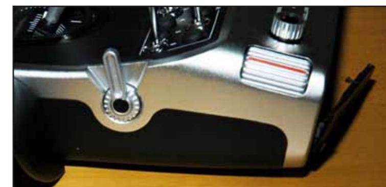
Dieser Drehschieber ist höchst Bruchgefährdet und sollte aus Metall sein
