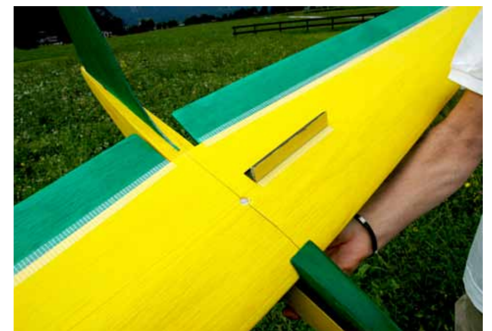
Einseitige Bremsklappe voll ausgefahren
