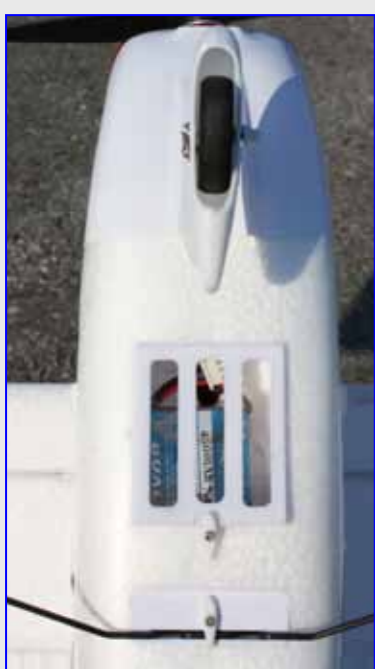
Der Akkusack für den 2s- 450mAh LiPo befindet sich auf der Unterseite unter einer Schutzabdeckung.
