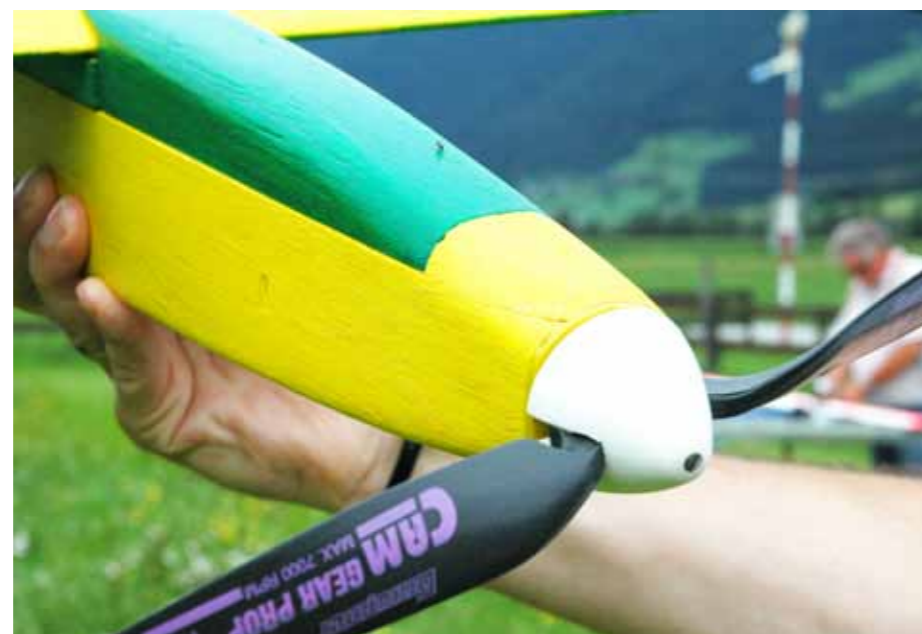
Fertige Rumpfspitze nach Verschleifen und Lackierung
