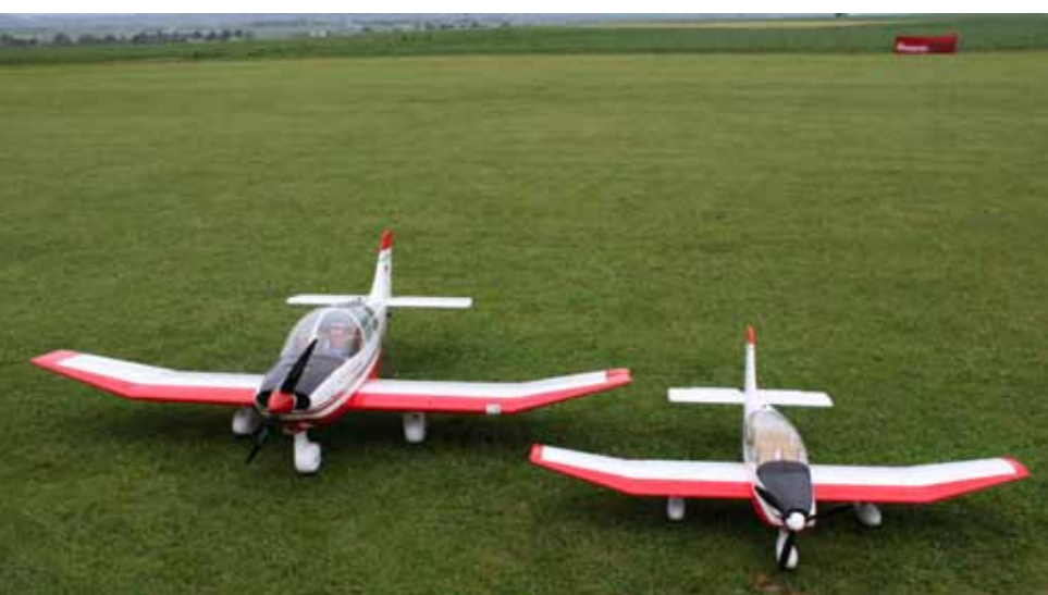
Moderne Jodel Robin DR400 (Spw. 2500mm) und historisches Modell aus 1978 neu aufgebaut (Spw. 1680mm), beide elektrisch angetrieben
