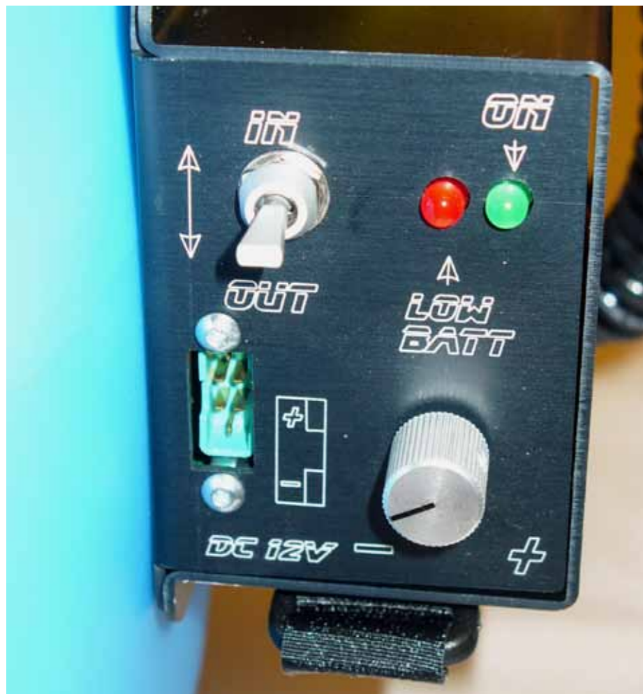
Hier ist das Bedienungspaneel zu sehen. Es beinhaltet einen Schalter zur Auswahl Betankung- Entleerung, zwei Kontroll- Leuchten für den Zustand des Versorgungsakkus und ein Drehpotentiometer zur Regulierung der Durchfluss- Geschwindigkeit. In dem Paneel ist weiters ein Multiplex- Stecker für den Anschluss des Versorgungsakkus integriert.
