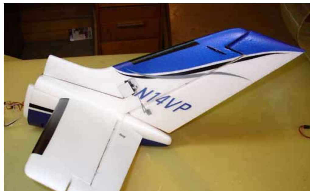
Das Heck der Twin Air mit den miteinander verschraubten Seiten- und Höhenleitwerk
