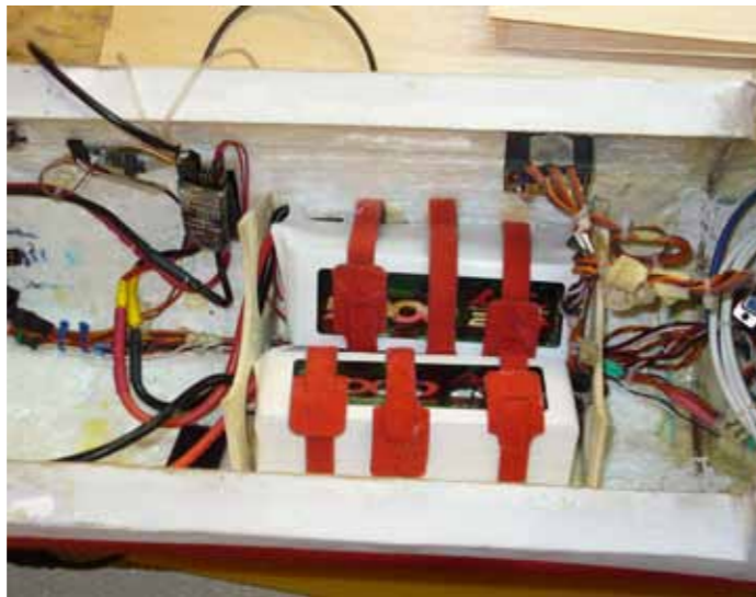
Zu sehen ist das Innere der DC9 mit seinen beiden 6s-LiPO Akkupacks der Fa. MIWO und den Kabelsträngen. Die Versorgung der Tragflächenservos erfolgt über einen 15 poligen Computerstecker.
