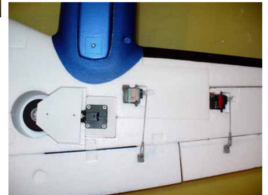
Wie beim Höhen- Seitenleitwerk sind auch beim Querruder die Scharniere und Anlenkungen einzubauen.
