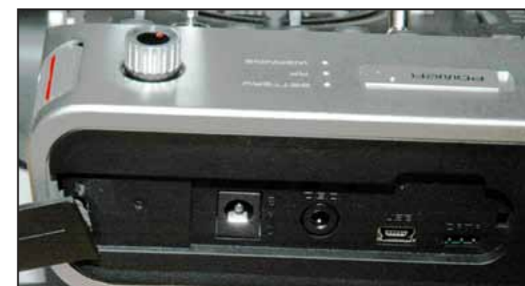
Hier ist Verbesserungsbedarf angesagt. Die Gummiabdeckung ist fast schon am Ende
