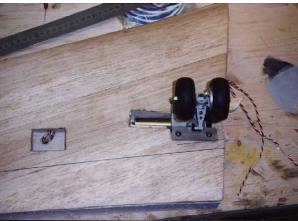
Das Hauptfahrwerk wird in der Tragflächenhälfte eingepasst und die zugehörigen Luftschläuche werden gleich mit eingebaut.
