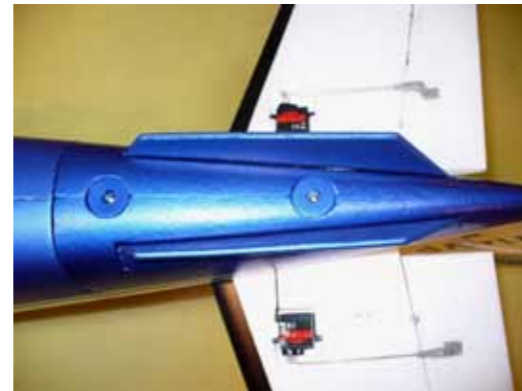
Hier sind die Schrauben mit dem das Seitenleitwerk am Rumpf befestigt wird zu sehen. Die beiden Finnen liegen ebenfalls separat dem Bausatz bei und sind in den entsprechenden Ausnehmungen einzukleben.
