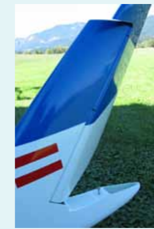
Seitenruderlagerung mittels Hohlkehle, gut zu erkennen, die Ausnehmungen für die Lagerungsplatten, die im Seitenleitwerk verklebt sind
