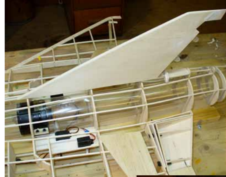
Nach dem Beplanken und Ausrichten des Seitenleitwerks auf dem Rumpf kann dieses mit dem Rumpf verklebt werden.
