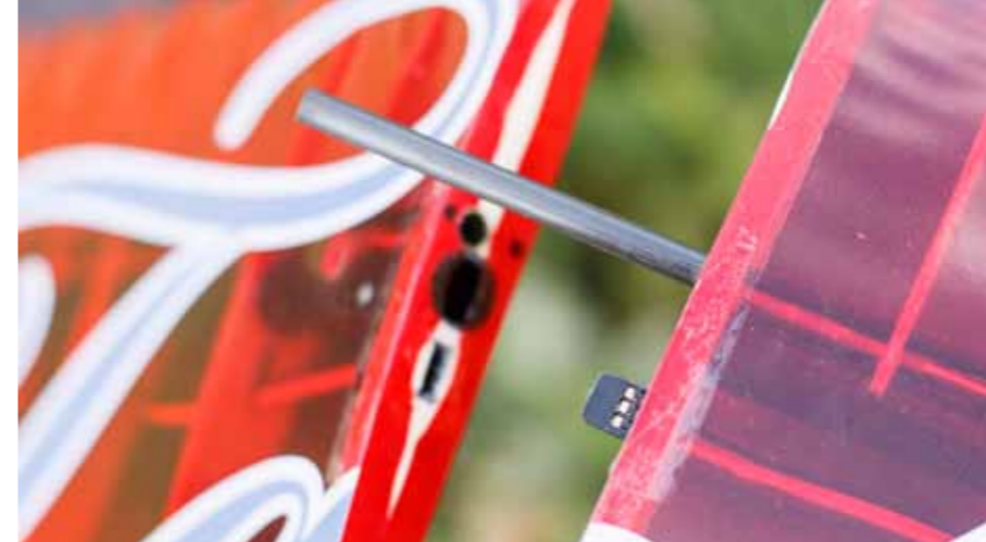
Stab und Stecker sind eingeklebt für schnelle Montage.
