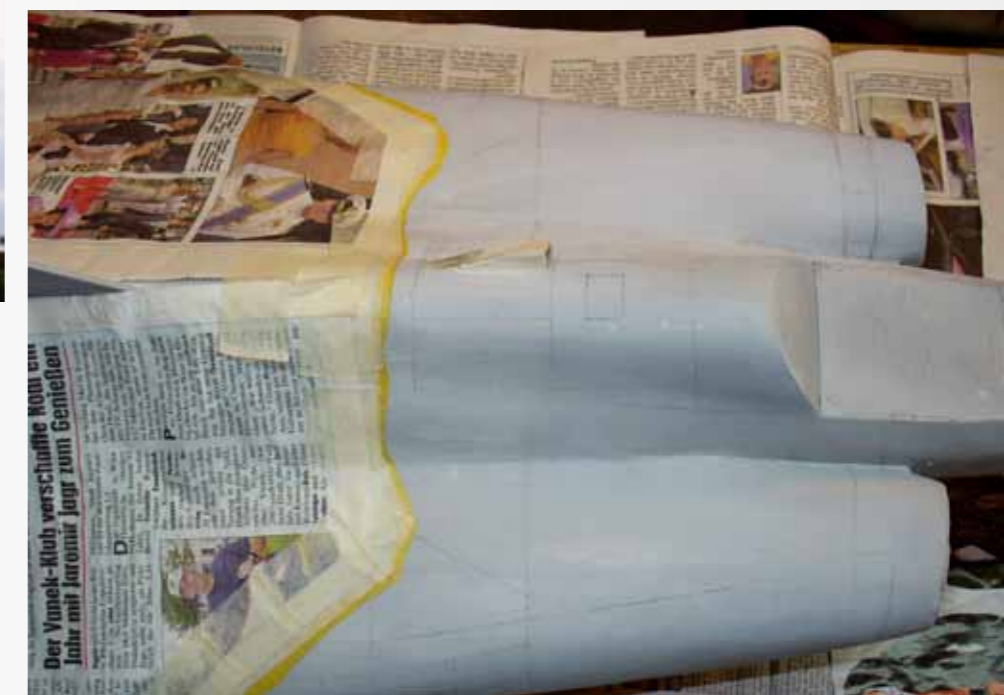
Die unterschiedlichen Farbschemas wurden durch Abkleben mit Maskier-Klebeband erreicht.
