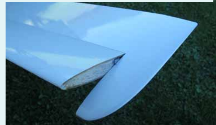
Vorderseite, gut zu sehen die Stützrippe beim Ruderausschnitt
