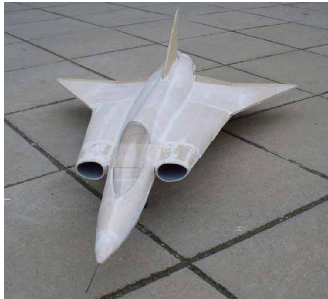
Das fertig beplankte Modell des Saab Draken vor dem Bespannen mit Glasgewebe.
