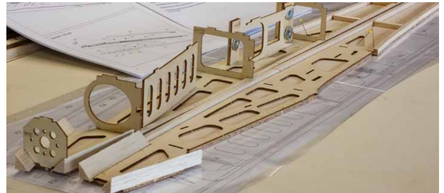
Die gelaserten Teile passen wie Legesteine ineinander
