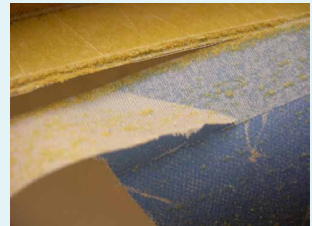
delaminiertes Abreißgewebe eines Querruders, leider kein Abdecklaminat verwendet
