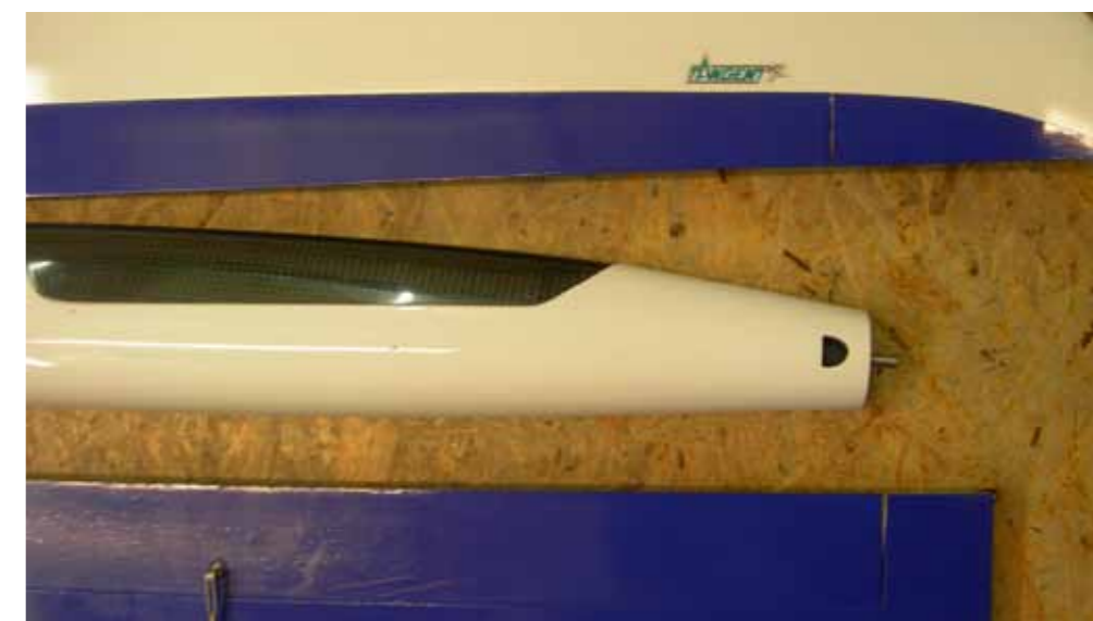
Der Motor ist bereits montiert, alle RC-Komponenten eingebaut, nur die Servoabdeckungen gehören noch montiert
