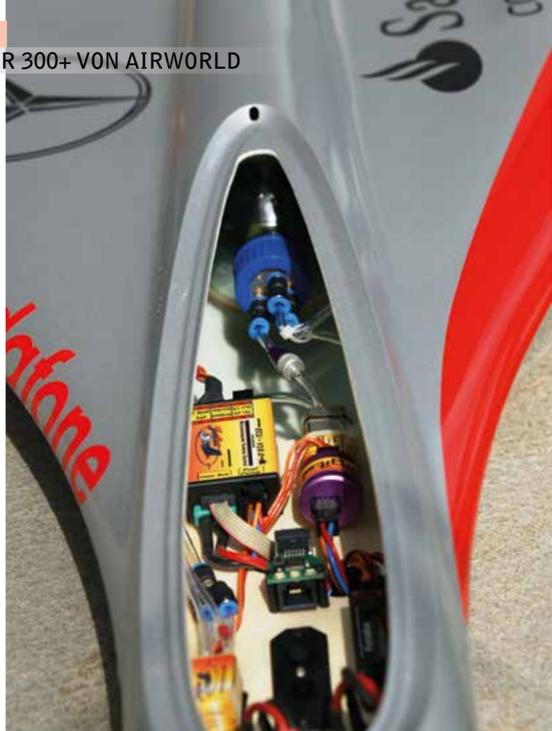
Einbausituation mit JetCat Turbinenelektronik und Tankeinbau mit PR-Medien Tankverschluss und Festo-Kupplungen
