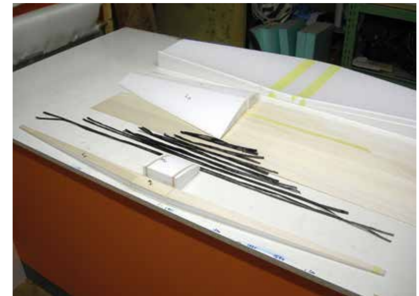
Die Materialzusammenstellung. Gut zu sehen die zwei Verstärkungsrippen im Wurzelbereich
