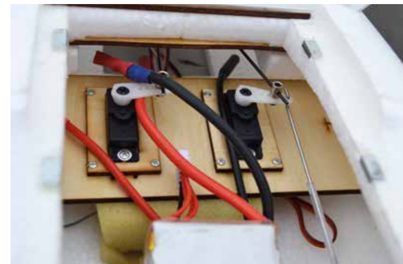
Fertig eingebaute Servos samt Gestänge
