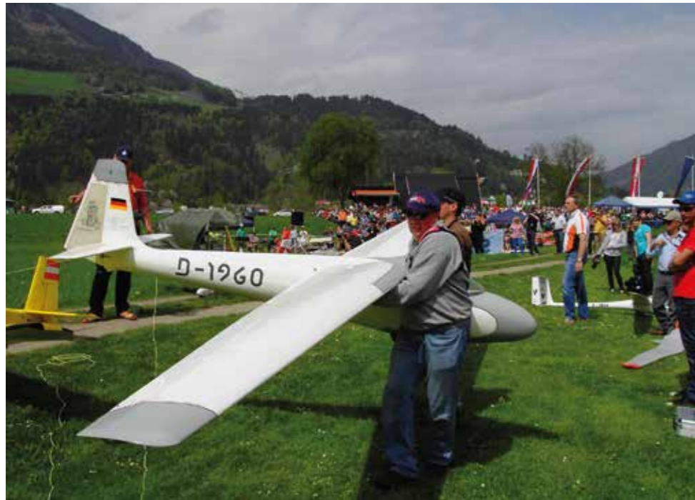
Gottfried Hirschers KA 10 A (7,25 m, 24,7 kg); Holzeigenbau: gleich aufgebaut wie das Original! - Foto: Markus Kozubowski
