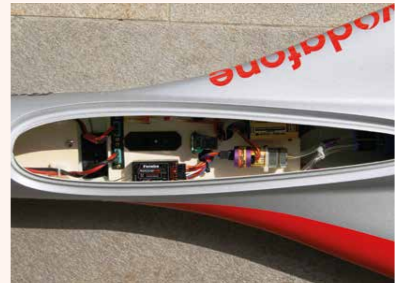
Cockpitbereich mit Einbausituation der JetCat-Turbinenelektronik, RC Komponenten robbe/Futaba R6008HS Empfänger sowie Power Box Systems switch mit Spannungsregulierung und den Akkusteckverbindungen RC und Turbine
