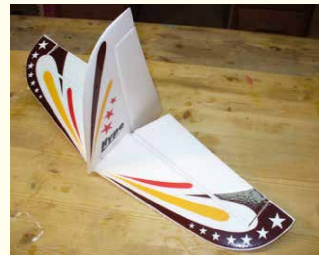
Vor dem Einsetzen des Seiten- Höhenleitwerks im Rumpf wird dieses ineinander gesteckt.
