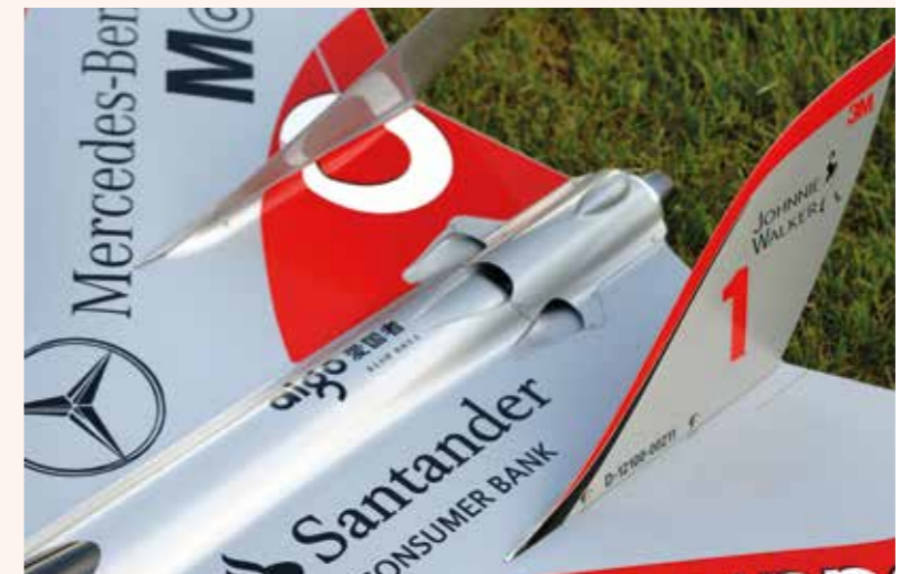
Turbinenbereich mit gut gelöster Abdeckung und Luftführung, welche für ein mehr an Zuluft vergrößert wurde.
