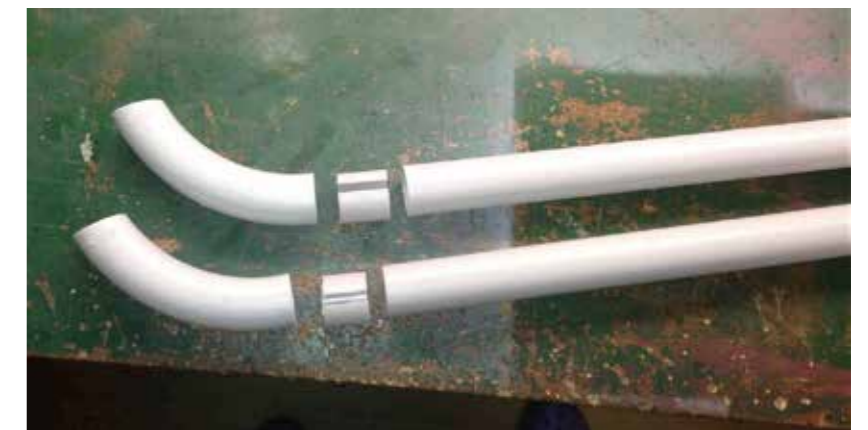
▲ Vor der Verklebung ▼ Kufen mit Verbindungsring
