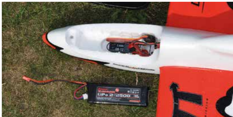
Zusätzlich eingebautes Vario montiert neben dem Empfänger GR 12 HoTT
