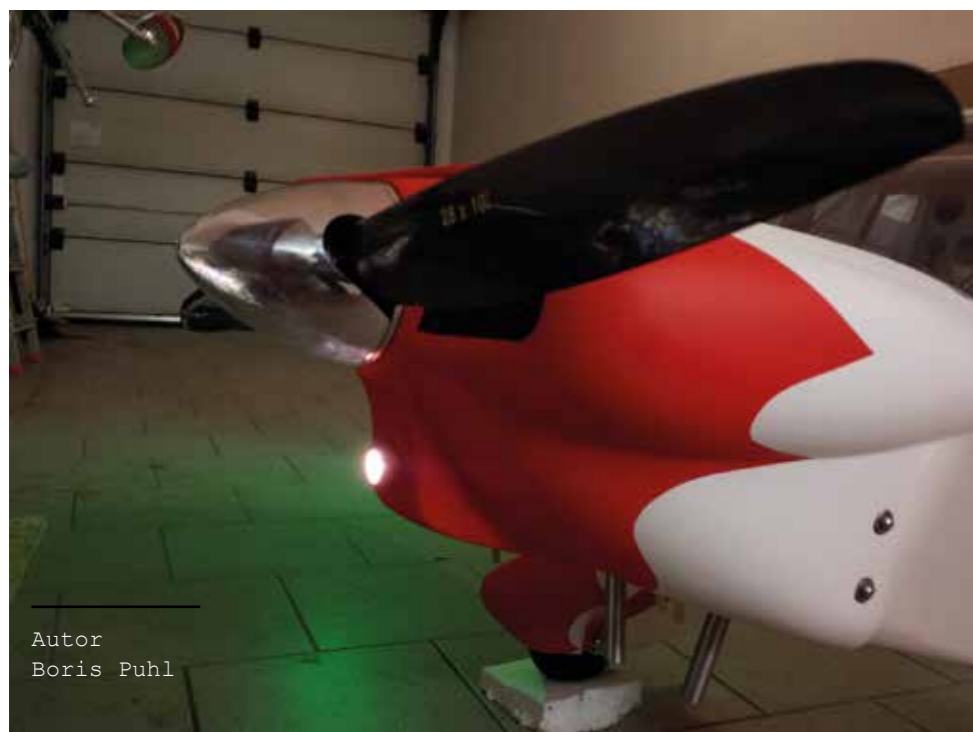
Eingebauter Landescheinwerfer in der Stirnseite der Motorhaube
