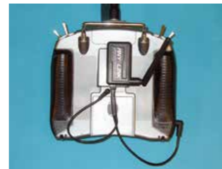
Anschluss des ANYLINK-Moduls am Beispiel der Spektrum DX6i-Fernsteuerung
