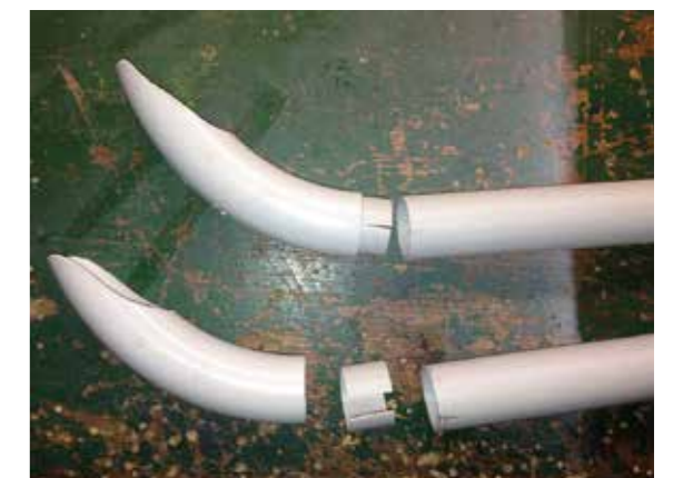
▲ Vor der Verklebung ▼ Kufen mit Verbindungsring
