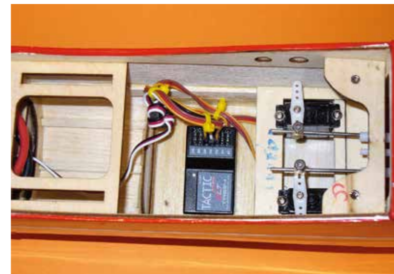
Im Inneren des Rumpfes ist genügend Platz zur Unterbringung des Empfängers und der beiden Servos zur Anlenkung des Höhen- und Seitenruders.
