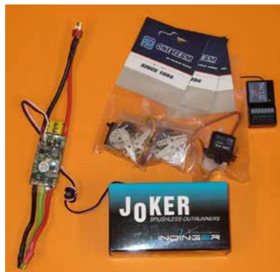
Zur Fertigstellung benötigt man noch drei 11 mm Micro Servos, einen 50A-Brushless Regler, einen Außenläufermotor mit 990kV sowie einen 6-Kanalempfänger.
