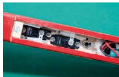
Die meisten Rumpfe – wie hier der PURES – sind knapp um die RC-Komponenten herum gebaut.
