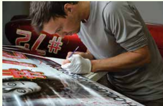
Freihändiges Outlineziehen mit dem Pinsel
