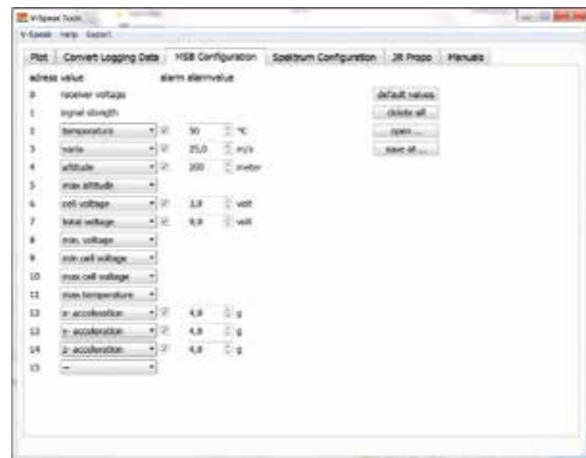
Einfache Einstellung der Parameter für M-LINK Adressen und Alarmwerte
