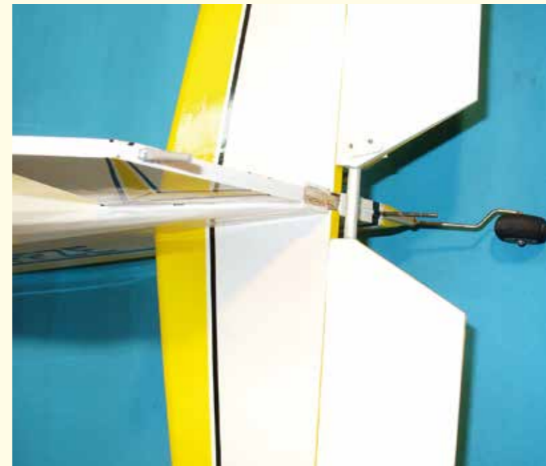
Zu den Fertigstellungsarbeiten gehört auch das Einpassen des Seiten- und Höhenleitwerks, sowie des Spornrades
