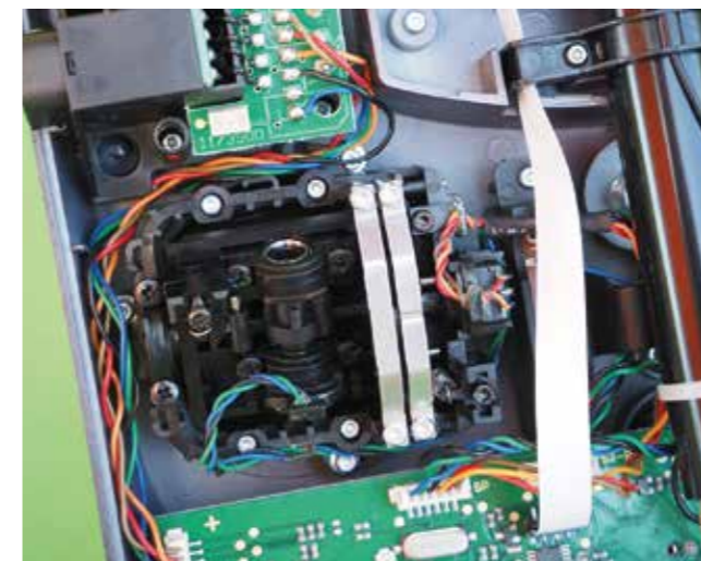
▲ Detail neue kugelgelagerte Knüppelaggregate ► Innenansicht nach Öffnung über zwei Schieber
