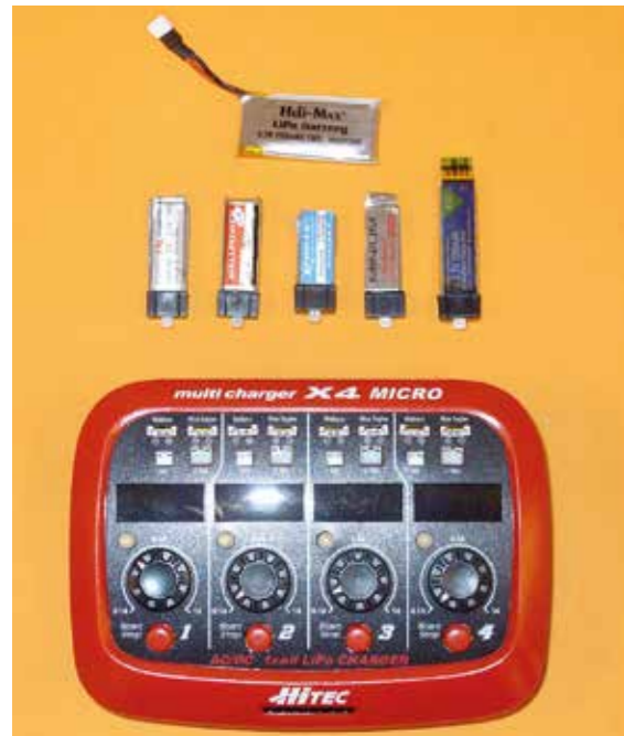
1S-LiPos mit den gängigsten Steckersystemen können nun mit einem Gerät geladen werden.
