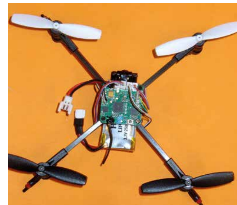
Zum Binden des 1SQV-Quadcopters an das „AnyLink-Modul“ bzw. an einen SLT-kompatiblen Sender muss die Haube abgenommen werden. Darunter befinden sich der Bindeknopf und die Anzeige-LED.
