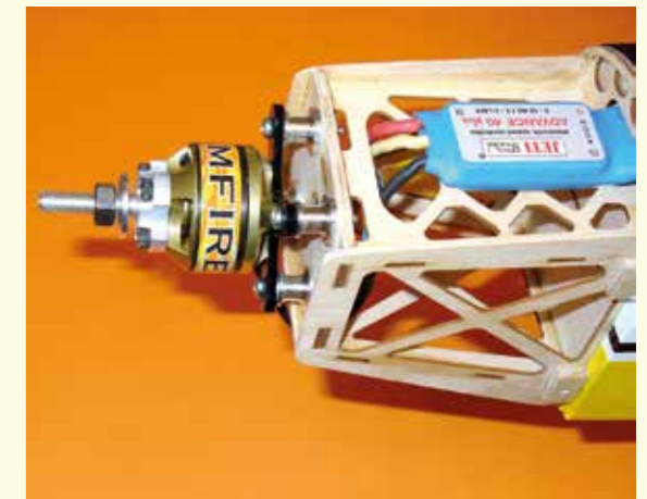
Für die Montage des RIMFIRE-Antriebsmotors liegen die Distanzhalter und Schrauben dem Bausatz bei. Auch der Motordom ist bereits werkseitig fertig aufgebaut.
