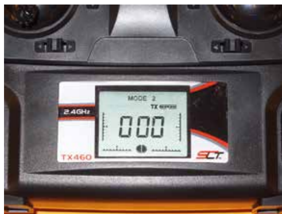
LCD-Display des Senders die mittlere Ellipse zeigt, in welchem Mode man sich befindet. Die Ellipse ist voll zu sehen, daher ist der Expertenmodus aktiv.
