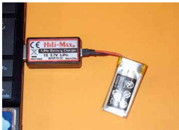
Das USB-Ladegerät lädt den Flugakku, wenn der Akku voll ist, blinkt die Kontroll-Leuchte nur mehr sehr langsam.
