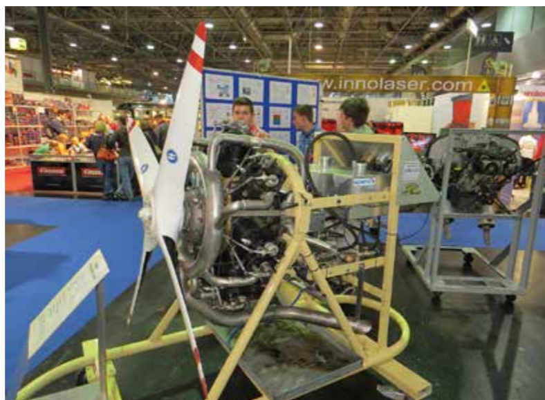
Am Stand der Bundesfachschule für Flugtechnik war dieser Siemens Halske (Sh 14 A4) Antriebsmotor zu sehen.
