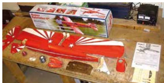
Der Bausatz ist bis auf die Antriebskomponenten, Servos, Empfänger und Luftschraube komplett ausgestattet. Sämtliche Kleinteile liegen dem Bausatz bei.
