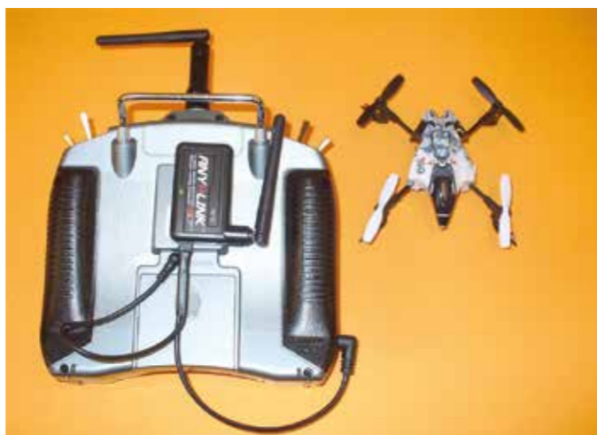
Wer einen anderen Mode fliegt oder seinen eigenen Sender verwenden will, greift auf das „AnyLink-Modul“ zurück.
