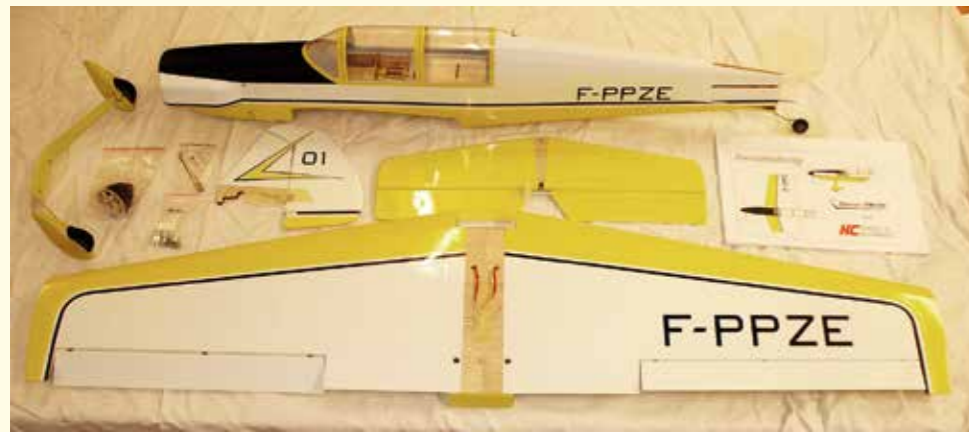
Der gelieferte Bausatz beinhaltet hochwertig gefertigte Komponenten. Bis auf die Servos, Antrieb und Regler sind alle benötigten Teile enthalten.
