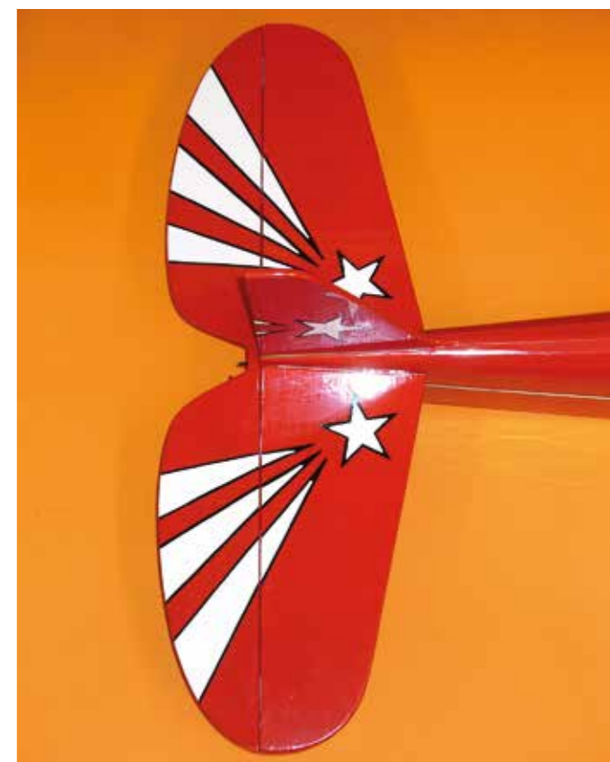
Ansicht des Höhen-Seitenleitwerks nach dem Einbau des Höhenruders. Das Einkleben des Seitenruders erfolgt erst nach der Positionierung des Spornfahrwerks am Rumpfe.
