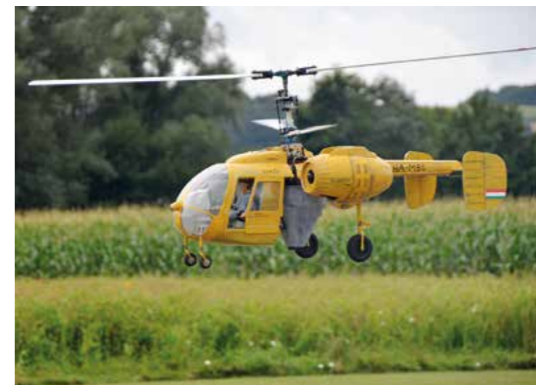
Ein sehr interessanter Scale-Nachbau eines Koaxial-Hubschraubers, KAMOV KA 26, Erbauer und Pilot H. Schloffer, Rotordurchmesser 1,8 m, 13,2 kg
