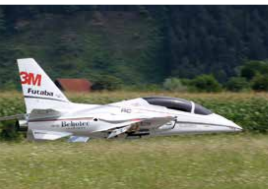
Udo Dettelbachers Viperjet ist ein Bausatz der Firma Paritech, den er souverän vor dem anwesenden Publikum präsentierte. Das Modell besitzt eine Spannweite von 3,45m, eine Rumpflänge von 3,05 m und wird von einer Behotec 220 angetrieben. Mit einem Abfluggewicht von 24,6 kg ist der Viperjet gerade noch unter der Zulassungsgrenze.
