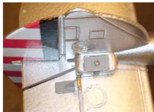
Nach dem Einkleben der beiden Seitenleitwerke in die Rumpfpylone erfolgt das Einsetzen und Verschrauben des Höhenleitwerks.
