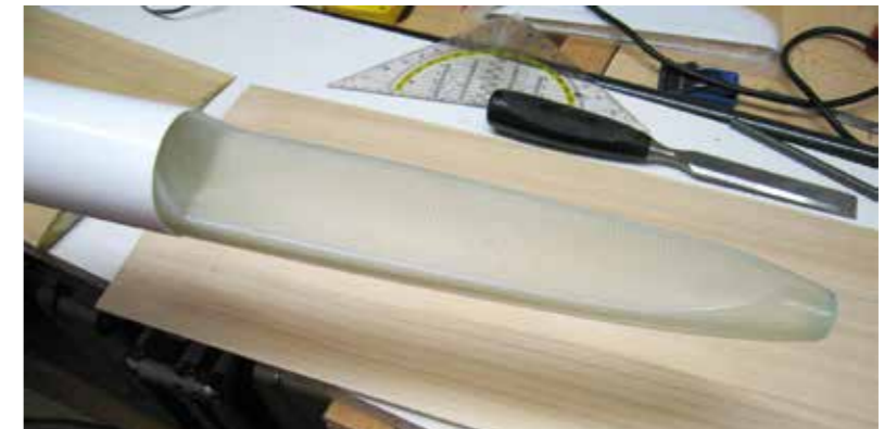
Der Rumpfkonus ist nach vorne abnehmbar und ermöglicht einen einfachen und schnellen Zugang zu allen RC-Komponenten und bietet ausreichend Schutz für die Elektronik. Je nach Bedarf wird der Ausschnitt gefräst.
