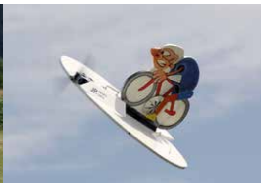
Ebenso beliebt war bei den Kindern das Abwerfen von Zuckerln und Luftballons aus dem fliegenden Radfahrer von Franz Kogler. Das Modell besitzt einen Scheibendurchmesser von 1,3m und ein Abfluggewicht von 6,5 kg, wobei die Zuladung 1,5 kg beträgt. Benötigt wird dazu ein 10s LiPo-Akku.
