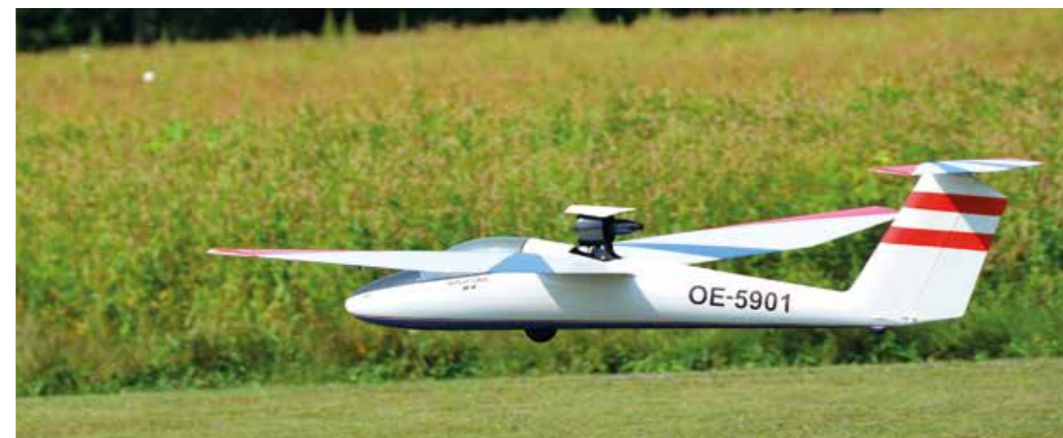
Mit einem jetähnlichen Geräusch erhob sich der Eigenbau-Segler von Kurt Winkelbauer, eine Pilatus B 4, in die Lüfte. Als Besonderheit weist dieses Modell einen im Rumpf versenkbaren Impellerantrieb auf. Techn. Daten: 4,8 m Spwte., 12,2 kg Abfluggewicht
