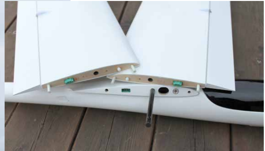
Fix und fertig hergestellt ist der Rumpf-Flächenübergang bereits im Lieferumfang enthalten
