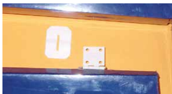
Bei den Ruderscharnieren sind welche aus Flies vorgesehen, jedoch erfolgte hier ein Austausch gegen solche der Type Kavan.
