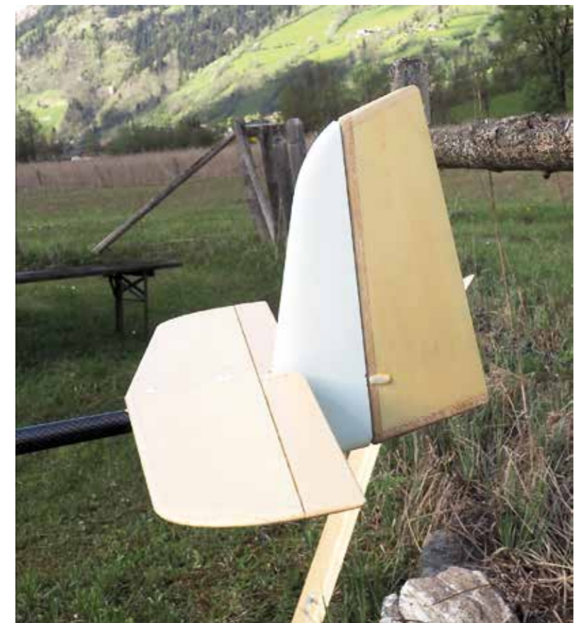
Das ungewöhnliche Leitwerk des Aspect. Das Höhenleitwerk besteht, so wie die Flächen auch, aus sauber geschnittenen Styroporkernen, furnierbeplankt mit Glasgewebe unterlegt und mit Luftfahrtharz verklebt.
