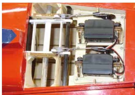
Das Höhenleitwerk ist als Pendelruder ausgeführt und wird über zwei DS590BBMG Servos und einer Wippe angelenkt.
