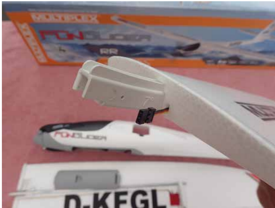
Einfache, aber effektive Flächenarretierung
