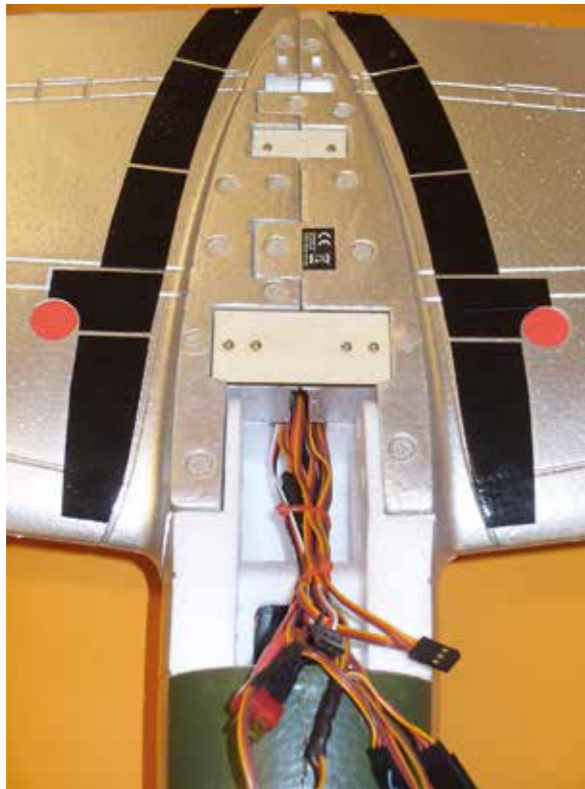
Die Verbindung der beiden Tragflächenhälften erfolgt mittels eines vorderen und rückwärtigen Verbindungsblättchens aus Sperrholz, die mit Hilfe von 3-mm-Schrauben im Rumpfboot befestigt werden.
