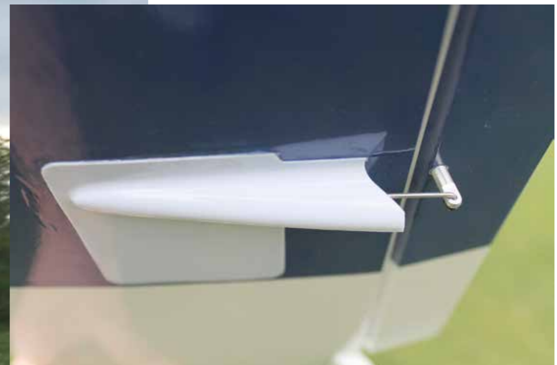
Die Anlenkung der Querruder ist durch eine Abdeckung gut vor Beschädigung während der Landung geschützt.
