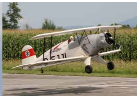
Eines der größten Modelle bei dem Airmeet war die Bucker Jungmeister von Wolfgang Rossegger. Das zulassungspflichtige Modell im Maßstab von 1:1,65 besitzt 4m Spannweite und wird von einem Moki 400 Sternmotor angetrieben.
