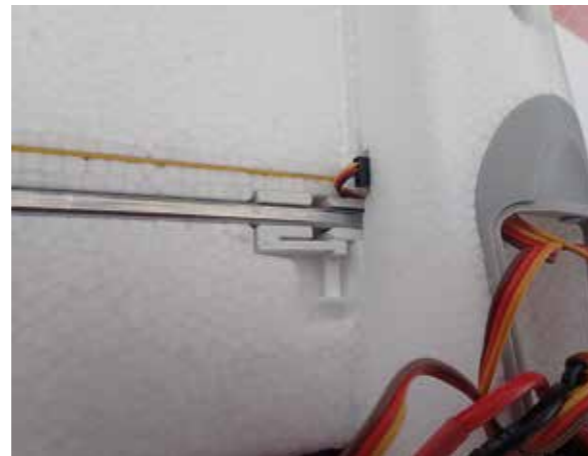
Einfache, aber effektive Flächenarretierung
