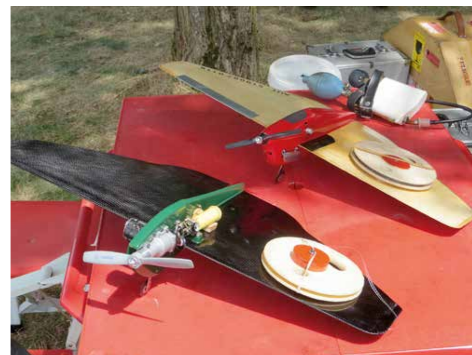
Vorne F2F-Racer, dahinter F2C-Racer, der Unterschied liegt in der Rumpfform.
