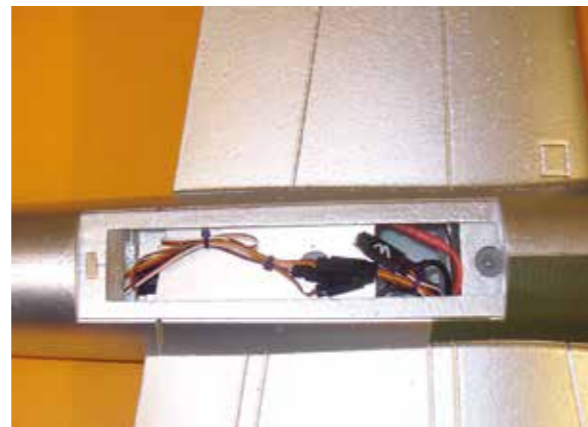
Nach dem alle Steckverbindungen hergestellt wurden, ist es zweckmäßig, gleich die Zuordnung der Servofunktionen zu überprüfen.
