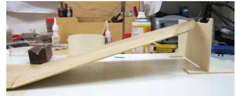
Die einzige „heikle“ Arbeit beim Bau des Aspect ist die genaue Positionierung der Aussenflügel.
