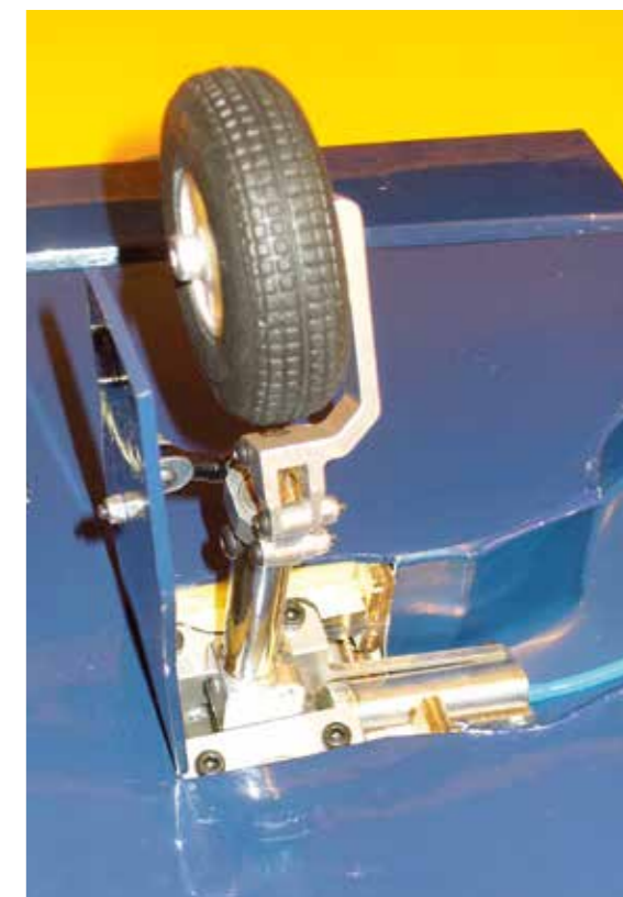
Der Einbau des Fahrwerks selbst ist unproblematisch und geht sehr schnell vor sich. Jedoch muss man aufpassen, dass beim Eindrehen der Schrauben in die Befestigungspunkte, die Einschlagmuttern sich nicht durch schräges Aufsetzen aus ihrer Verankerung lösen.
