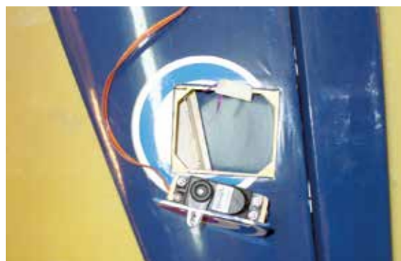
Als Servos kommen die von Boomerang Jets vorgeschlagenen DS595BBMG der Marke D-Power zum Einsatz. Hierbei handelt es sich um Servos der 10-kg-Klasse, die perfekt in die bereits vorbereiteten Servohalterungen passen.
