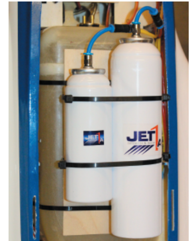
Die Tanks für das Einziehfahrwerk und der Bremse werden mittels Kabelbinder und Zwischenplatte am Treibstofftank befestigt.
