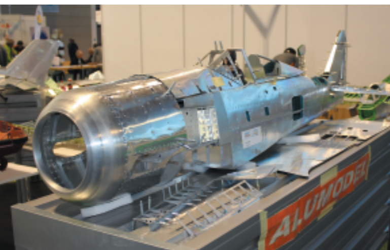
Die US-amerikanische Firma Alumodel bietet Bausätze wie diese FW-190 aus Aluminium an. Die Modelle werden komplett in CNC und CAD Technik aus Aluminium aufgebaut und Nieten sorgen für den notwendigen Halt.
