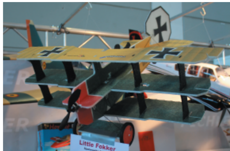
Die kleine LiL-Fokker von Modellbau Pichler besitzt eine Spannweite von 680 mm, eine Länge von 650 mm und ist komplett aus EPP hergestellt.
