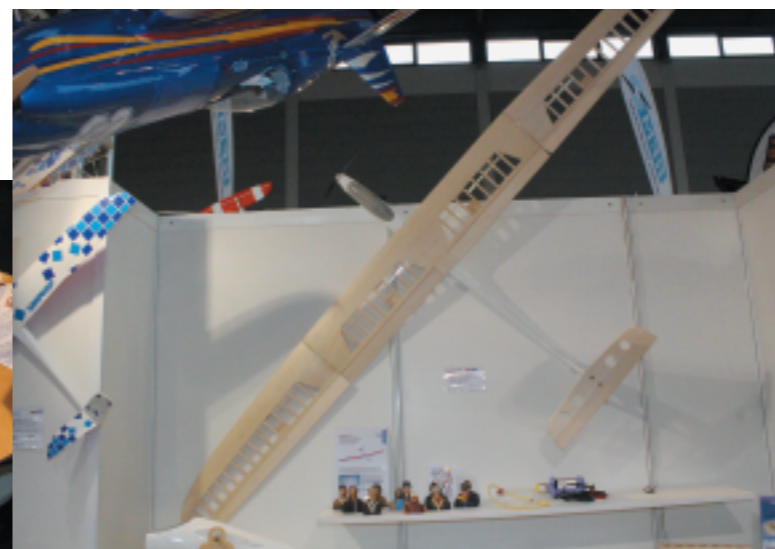
Die Firma Simprop hat das neue Elektro-Segelflugmodell Tevarius mit einer Spannweite von 3.040 mm und einem Fluggewicht von 1.900 bis 2.500 g im Programm.
