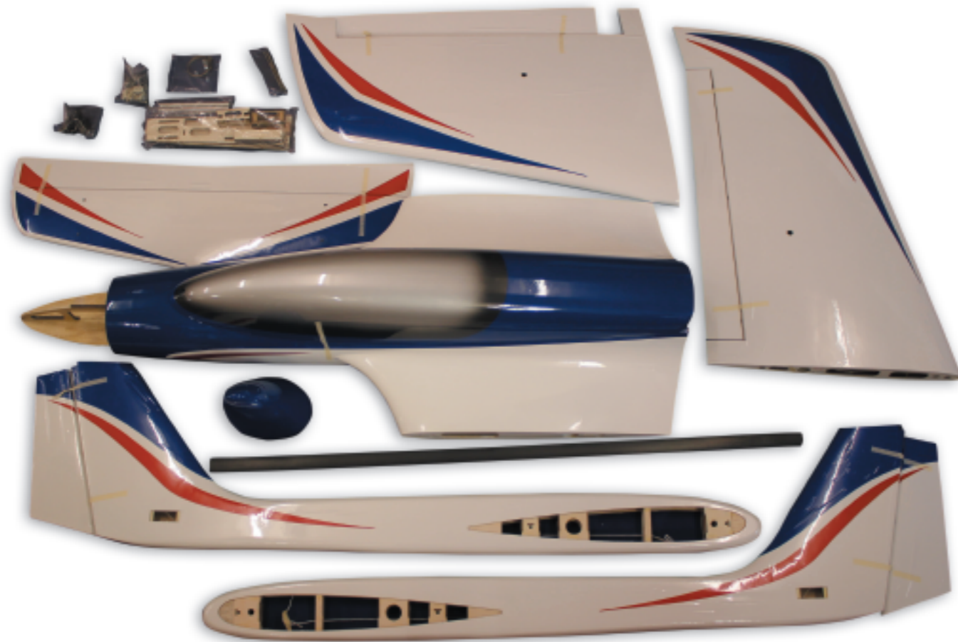
Geliefert wird das Xcalibur Modell mit fertigen Komponenten samt den benötigten Zubehörteilen. Gesondert müssen nur noch die Turbine, das Fahrwerk, der Tank und die elektrischen Komponenten beige stellt werden.
