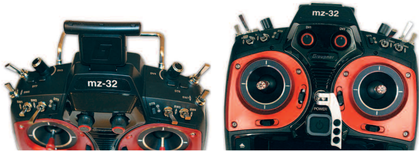
Im oberen Bereich sind eine Vielzahl von Schaltern, Drehgebern und die klappbar zirkular polarisierte Patchantenne mit kombinierter quer eingebauter Antenne angeordnet.
