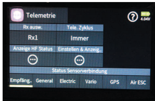
Bei der Telemetrie werden die im Modell eingebauten Sensoren und Module angezeigt. Im Feld „Rx ausw.“ kann bestimmt werden, welcher Empfänger die Telemetriedaten überträgt. Mit dem Feld „Tele Zyklus“ kann bestimmt werden, ob der Übertragungszyklus verlangsamt oder ausgeschaltet wird.
