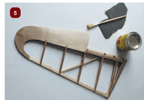
Nach dem Feinschliff erhält die neue Beplankung einen Anstrich mit Porenfüller.
