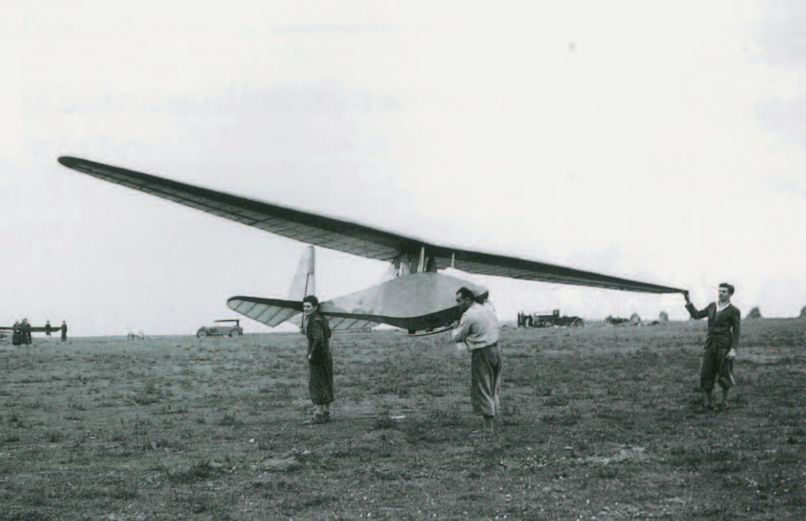
Um die Flugeigenschaften kleiner und leicht gebauter Maschinen zu erproben, wurde die Gelse, offiziell "HR.1" als Versuchsflugzeug gebaut.
