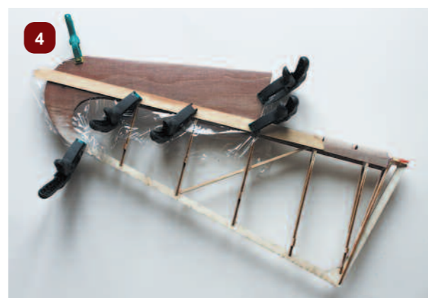
Das Austrocknen erfolgt direkt am zu beplankenden Bauteil, wobei hier auf die Frischhaltefolie nicht vergessen werden darf.
