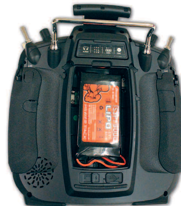
Auf der Rückseite unter der Klappe des Akkuschachts befindet sich der 1s3p LiPo-Akku mit 9.000 mAh. Er ermöglicht einen Betrieb des Senders von bis zu zehn Stunden.
