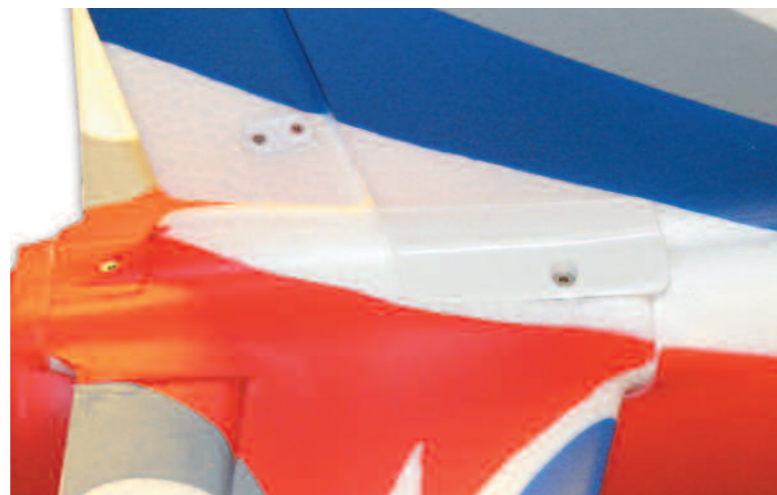
Die Montage des Seitenleitwerks erfolgt mit denselben Schrauben, die auch das Höhenleitwerk am Rumpf fixieren.
