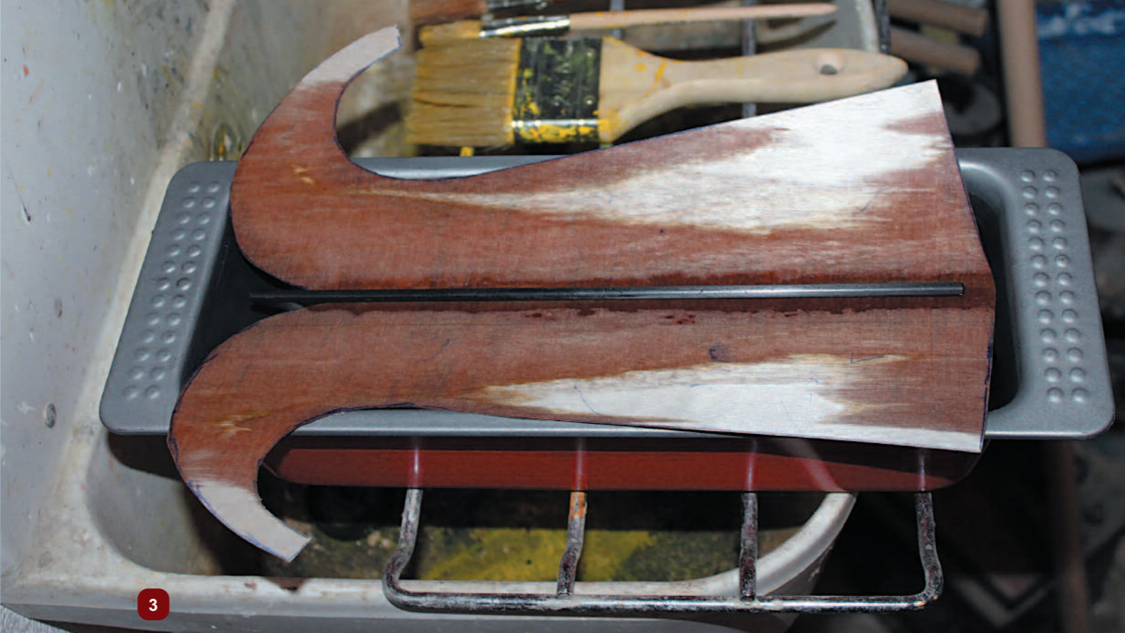
Das Sperrholz wird eingeweicht und der Bereich der Nase wird dabei vorgebogen.
