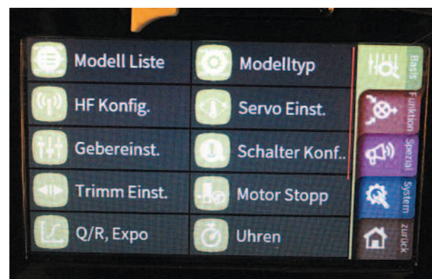
Vierfärbig unterschiedlich gekennzeichnete Untermenüs bieten eine Vielzahl von Einstellmöglichkeiten und Funktionen. Sie bilden die Grundbasis der Programmierstruktur der Mz-32.
