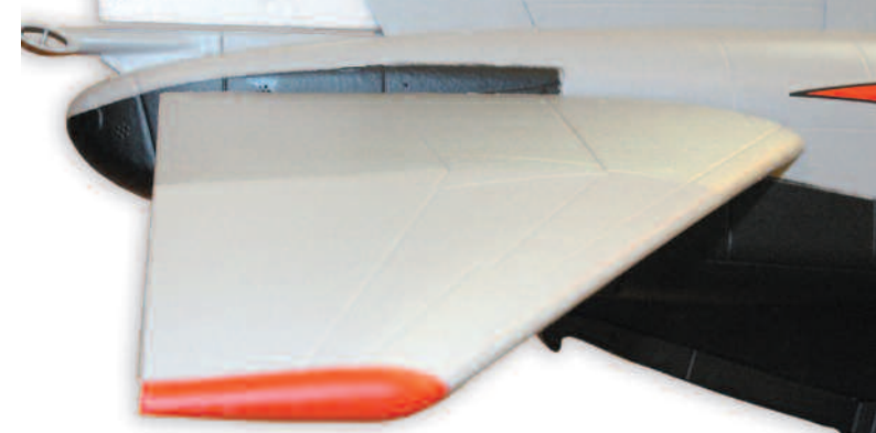
Das Höhenrudder muss vorne leicht nach unten stehen, damit die F4 Phantom neutral fliegt.
