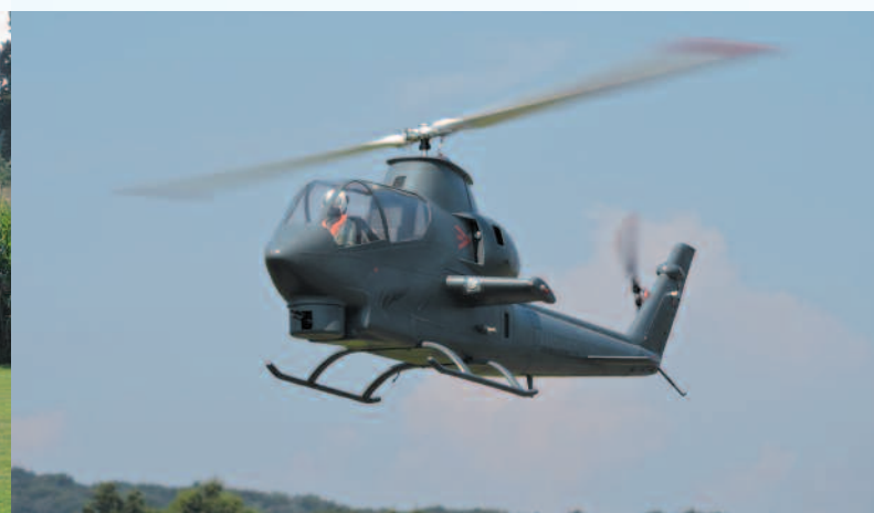
Wolfram Kügler brachte eine Bell „Cobra“ mit und präsentierte sie vorbildgetreu im Flug; 1.800 mm Rotordurchmesser, 10.000 Gramm, Akku 12s.
