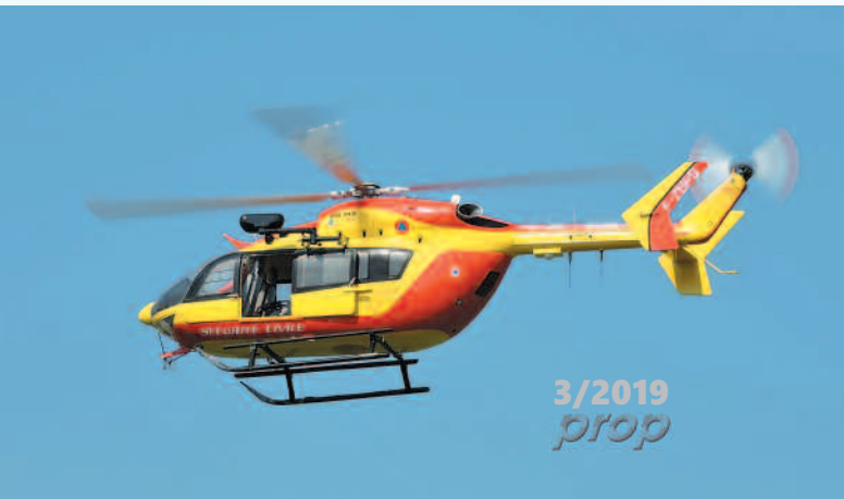
EC 145 Eurocopter von Gerald Serschen, 1.700 mm Rotordurchmesser, 12.000 Gramm, Akku 12s.
