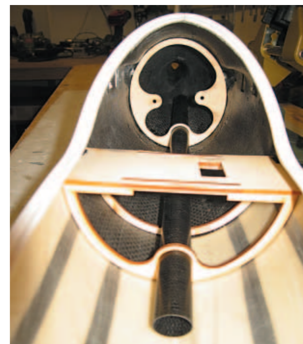
Die vorgefertigten Spannten passen sehr gut. Die Positionierung des Ballastrohres sowie dessen Verwendung bleibt dem Erbauer überlassen. (Bauanleitung wäre da sehr vorteilhaft.)
