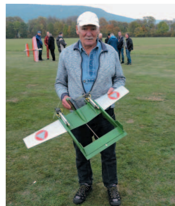
Franz Marksteiner hier mit einem rasanten und lautem, aus Balsaholz bestehenden Rennflugzeug. Die beiden Antriebe „MF 15“ (2,5 cm 3 ) kommen aus der Motorenschmiede von Franz, haben 2,5 cm 3 und Combat-Propeller, Spannweite von 850 mm.
