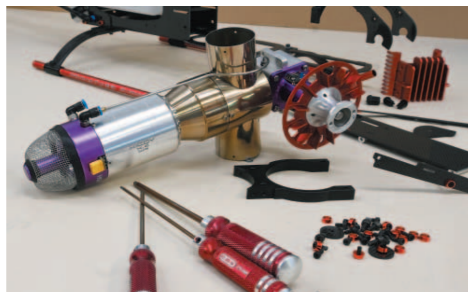
Die Xicoy Turbine ist etwas länger und schlanker als die bisher verbaute Turbine Solutions TS45i. Somit musste die CFK-Platte für die Batterieaufnahme im vorderen Bereich des Helis geändert werden. Zusätzlich erfolgte die Änderung der Position einiger Abstandsbolzen im Chassis.
