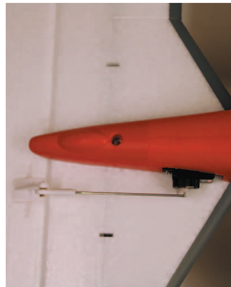
Das Höhenleitwerk in dem am Rumpfende vorgesehenen Ausschnitt eingeschoben und mittels einer Schraube M3 x 26 mm fixiert. Das im Zubehörbeutel befindliche Gestänge wird anschließend eingehängt und auf Neutrallage eingestellt.
